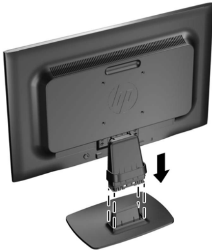
圖示 2-1 安裝顯示器底座
