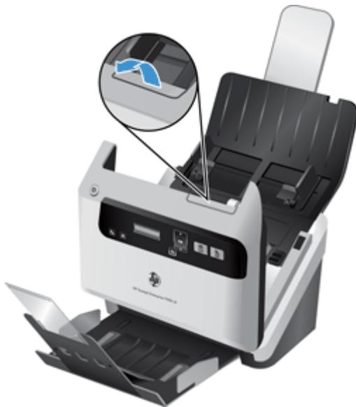
3. En la parte trasera de la tapa del alimentador de documentos abierta, levante las cubiertas de los rodillos de alimentación para acceder a los rodillos de alimentación superiores.
