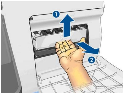
4. Heben Sie den Druckkopfreinigungsbehälter an, und ziehen Sie ihn aus dem Schacht heraus.
