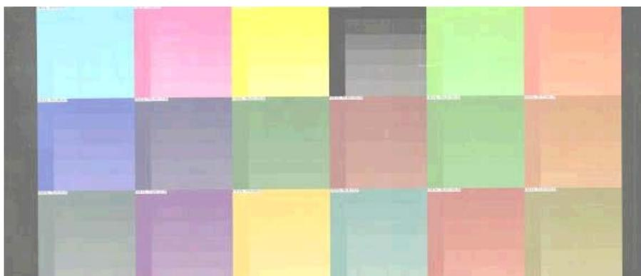
Erhöhen Sie die Tintenmenge in der RIP-Software, drucken Sie das Muster erneut, und führen Sie die Überprüfung noch einmal durch.
