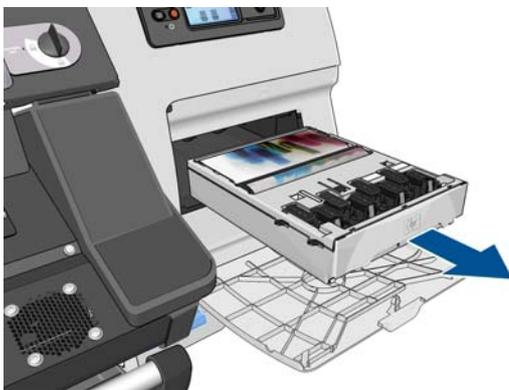
5. Sie können die Kunststoffverpackung des neuen Druckkopfreinigungsbehälters zur Entsorgung des alten Behälters verwenden.
