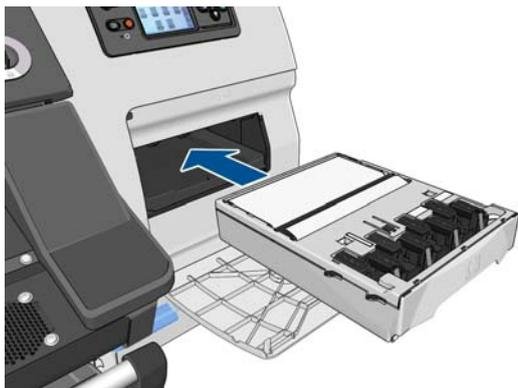
8. Wenn Sie den Druckkopfreinigungsbehälter vollständig eingesetzt haben, drücken Sie ihn wie gezeigt nach innen und nach unten, bis er einrastet.
