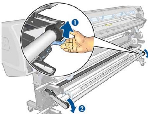
3. Drücken Sie die Spindelarreterung nach oben, damit die Spindel freigegeben wird.
