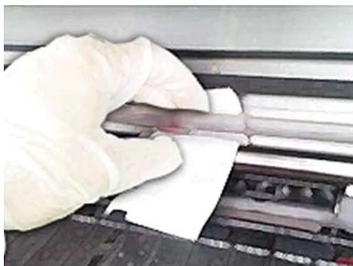
4. Warten Sie, bis die Schiene trocken ist, und schließen Sie dann das Fenster. Der Wagen bewegt sich in die Mitte des Druckers, sodass Sie den Teil der Schiene unter der rechten Abdeckung erreichen können.
