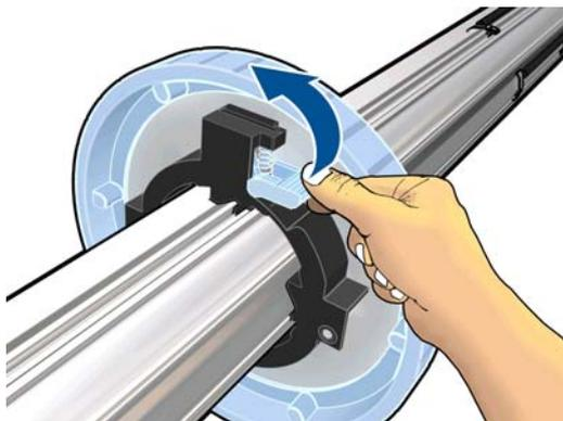
6. スピンドルの左端からストップを取り外します。
