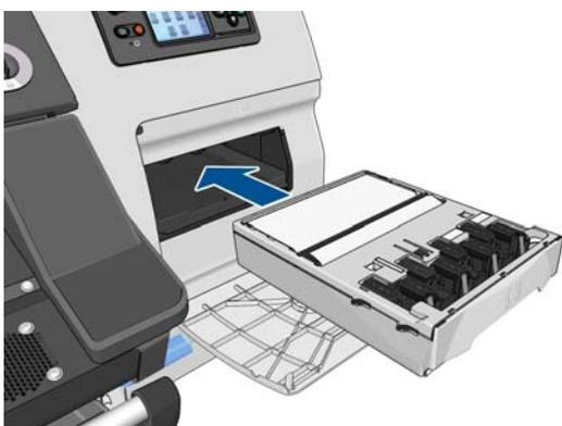
8. プリントヘッドクリーニングカートリッジが奥まで入ったら、下の図の矢印のように、奥に押しながらカチッと音がするまで下方向に押し下げます。
