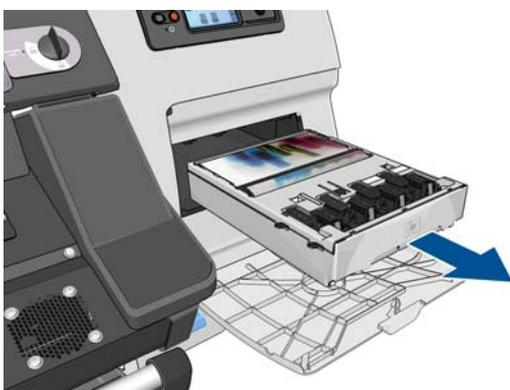
5. La bustina di plastica in cui viene fornita la nuova cartuccia di pulizia delle testine di stampa può essere utilizzata per riporre la cartuccia sostituita.
