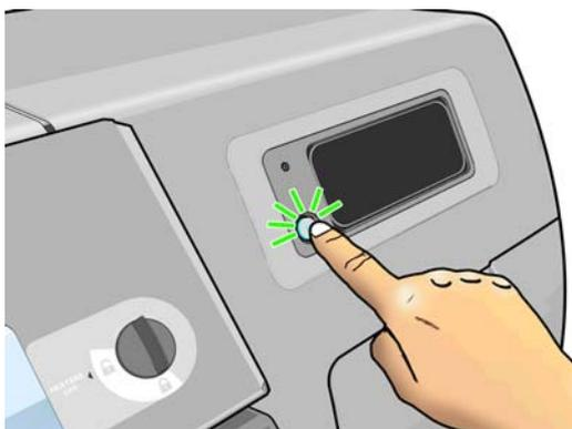
Quando si spegne la stampante in questo modo, le testine di stampa vengono automaticamente riposizionate insieme alla cartuccia di pulizia delle testine di stampa, per impedire che si asciughino.
