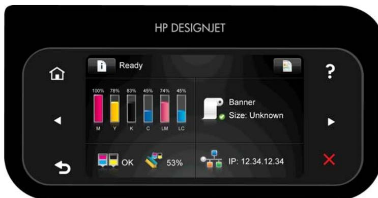
Se viene visualizzata questa schermata senza l'indirizzo IP, la stampante non è connessa correttamente alla rete o la rete in uso non dispone del server DHCP. In quest'ultimo caso, è necessario impostare l'indirizzo IP manualmente: vedere [Impossibile ottenere un indirizzo IP a pagina 153](#).
