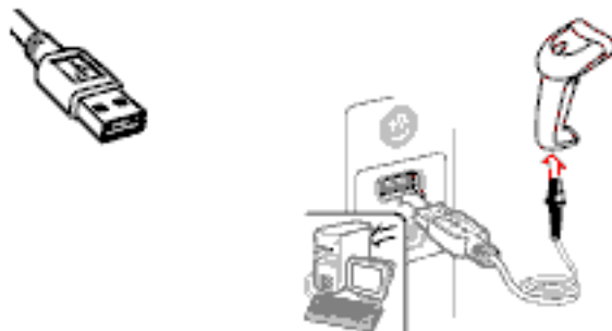
Slika 1-2 Spajanje USB sučelja
