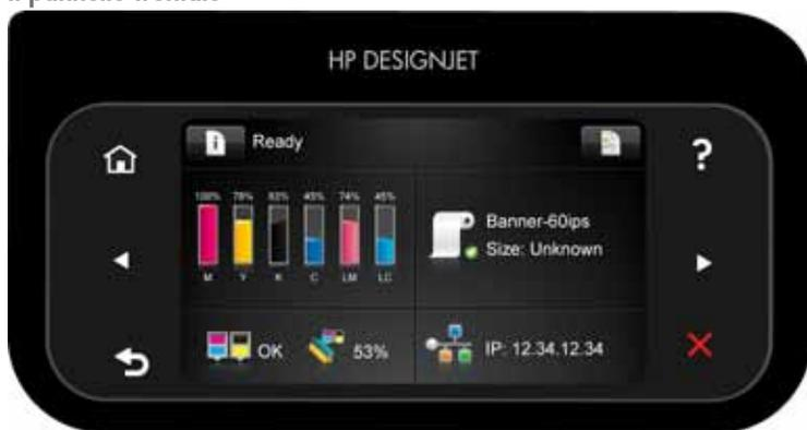
Il pannello frontale è dotato di un'ampia area centrale per la visualizzazione delle icone e delle informazioni dinamiche. Sul lato destro e sinistro è possibile visualizzare fino a sei icone fisse, in momenti diversi. Solitamente non vengono visualizzate nello stesso momento.
