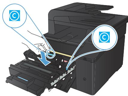
9. 竖直向上拉碳粉盒左侧的拉环，以完整地取出密封胶带。撕下密封胶带。
