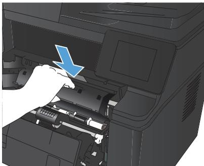
6. A instalação está concluída. Coloque o cartucho de toner usado na caixa do cartucho novo. Consulte o guia de reciclagem anexo para obter instruções sobre reciclagem.
