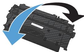
4. Incline a guia localizada no lado esquerdo do cartucho até soltá-la. Puxe a guia até que a fita seja removida do cartucho. Coloque a guia e a fita na caixa do cartucho de toner para devolvê-la para reciclagem.
