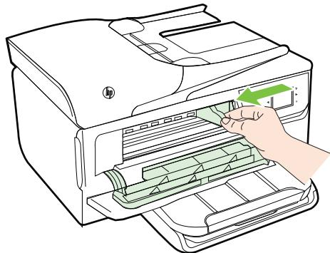
**⚠ Осторожно** Запрещается прикасаться к внутренним деталям принтера, если он включен, а каретка застряла. При открытии крышки доступа к картриджам каретка должна переместиться в исходную позицию в правой части принтера. Если каретка не перемещается, выключите принтер, прежде чем устранять замятие.
