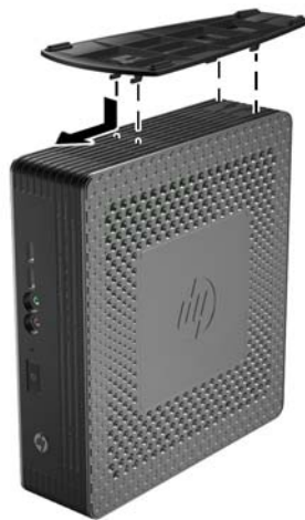
Figura 1-5 Instalación de la base
