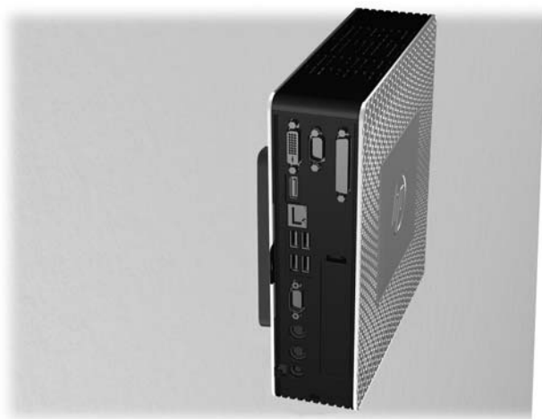
Figura C-6 Thin client montado en la pared
