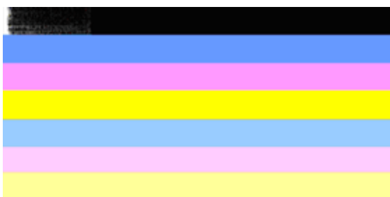
较差颜色条的示例 顶部黑色颜色条一端带有锯齿。
