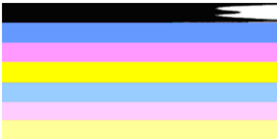
较差颜色条的示例 顶部颜色条有不规则条纹或者褪色。
