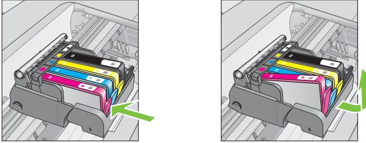
4. 向後拉橘色拉式垂片，從墨水匣取下塑膠包裝紙，就可以從其包裝取出新的墨水匣。
