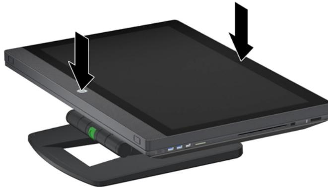
4. Fassen Sie mit einer Hand die untere Kante der Workstation so, dass Sie den grünen Knopf am Standfuß (1) drücken können. Fassen Sie den Griff an der Oberseite der Workstation mit der anderen Hand (2). Drücken Sie den grünen Knopf und halten Sie ihn gedrückt, während Sie die Workstation bis zu ihrer maximalen horizontalen Höhe (3) aufrichten.
