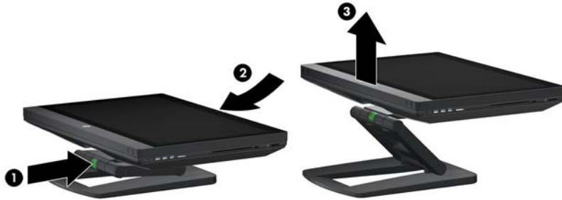
Figure 3-2 Soulèvement de la station de travail
