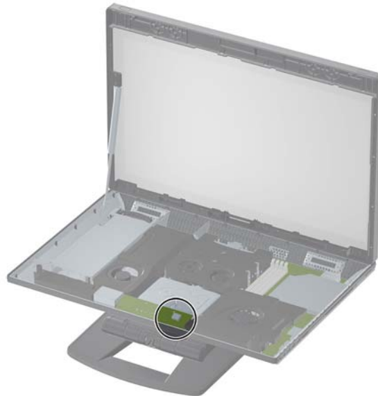
Figure 3-12 Installation du récepteur
