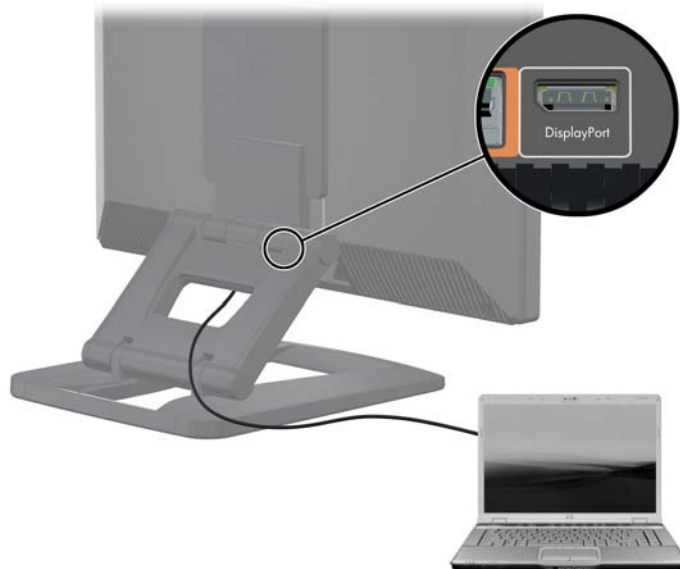
Figura 3-14 Collegamento delle porte del display
