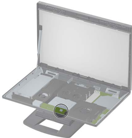
Afbeelding 3-12 Het installeren van de ontvanger
