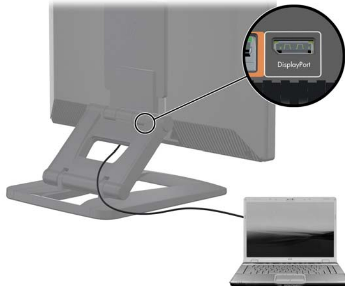
Figura 3-14 Conexión de puertos para pantalla
