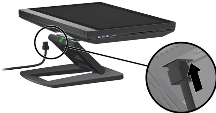
Figura 3-3 Conecte el cable de alimentación
