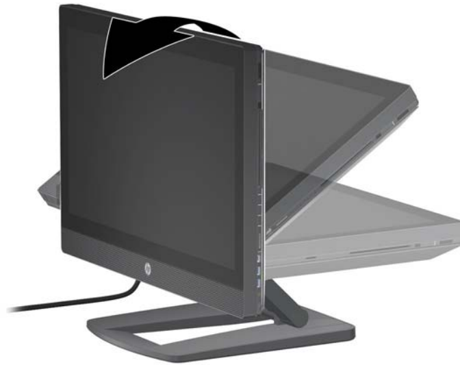
Figura 3-4 Acomode a una posición erguida
