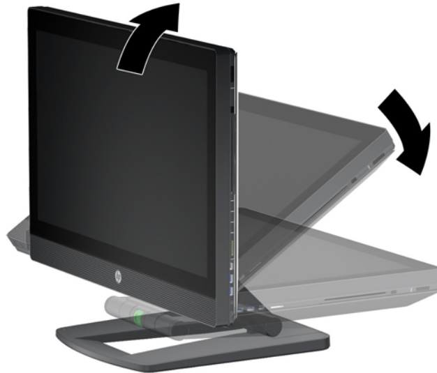
Figura 3-10 Acomode la estación de trabajo en posición horizontal
