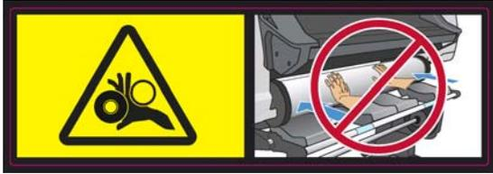
手が巻き込まれる危険。取り付け時にロールを押さないでください。取り付けテーブルを上げると、スピンドルをプリンタに簡単に取り付けることができます。
