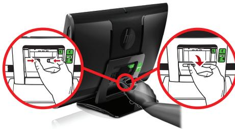
2. Accédez à la cavité arrière formée par le support de l'ordinateur et branchez le cordon d'alimentation sur le connecteur d'alimentation situé dans l'angle supérieur droit de la cavité.
