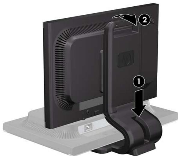
**📝 REMARQUE :** Lorsque le moniteur est déployé pour la première fois, la tête de l'écran est verrouillée pour éviter de se régler sur la position pleine hauteur. Pour régler la tête de l'écran sur la pleine hauteur, appuyez sur la tête de l'écran vers le bas pour la déverrouiller puis tirez sur la tête pour la monter en position pleine hauteur.
