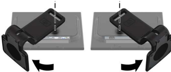
4. Faites pivoter le socle du moniteur vers le haut (1), puis tirez-le vers l'arrière (2) pour retirer des fentes du moniteur les languettes qui se trouvent sur sa base.
