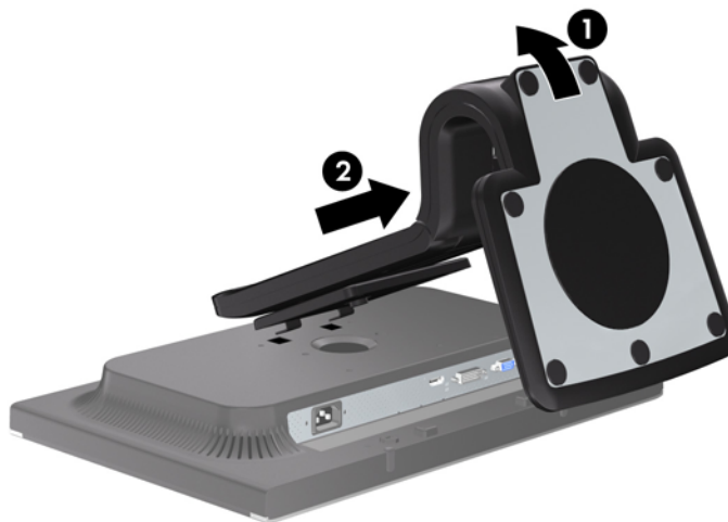
Figura 2-10 Extracción de la Base del Pedestal
