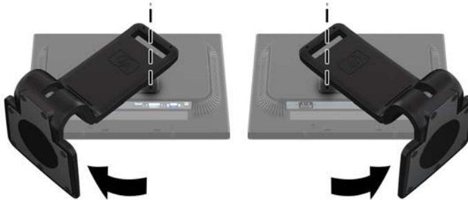
Figura 2-9 Extracción de los Tornillos de la Base del Pedestal
