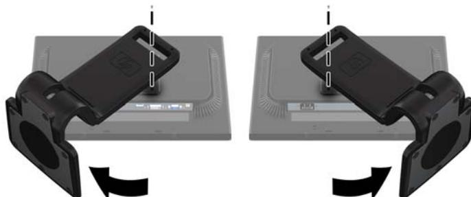
4. Gire a base do monitor para cima (1) em seguida puxe-a para baixo (2) para soltar as guias na base do monitor dos slots no monitor.
