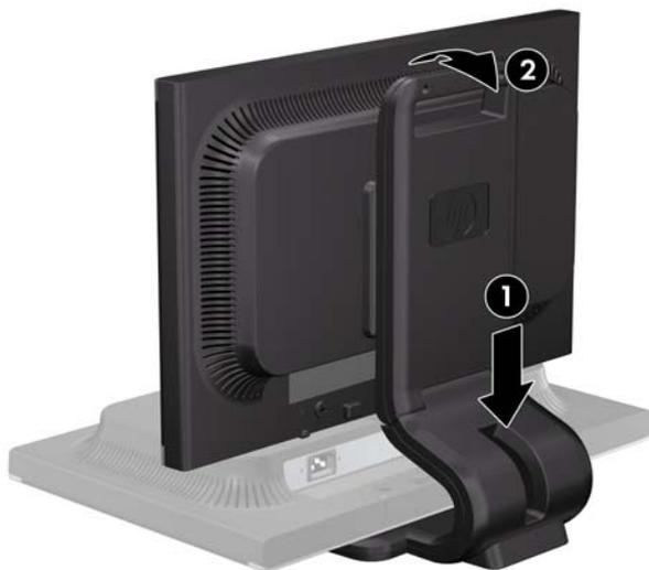
**📝 NOTA:** Quando o monitor é aberto pela primeira vez, o cabeçote da tela está bloqueado para ajuste em uma posição de altura total. Para ajustar o cabeçote do monitor na altura total, pressione o cabeçote do monitor para baixo para desbloqueá-lo então puxe-o para levantá-la até a posição de altura total.
