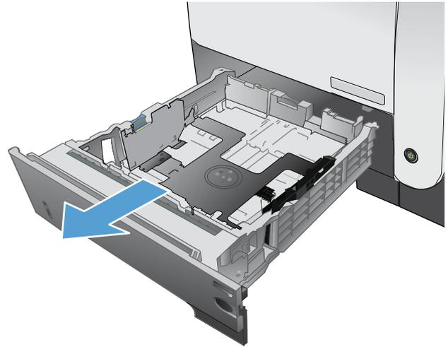
2. Pincez le levier de verrouillage du guide gauche et positionnez les guides latéraux sur le format adéquat.
