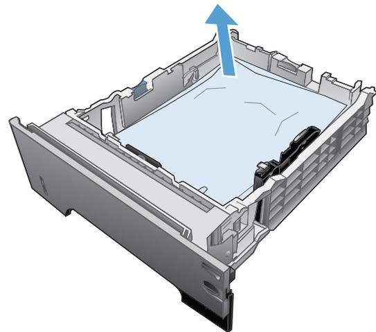
3. Vérifiez que le guide arrière du papier est réglé pour le bon format de papier. Si nécessaire, pincez le loquet de désenclenchement et placez le guide arrière du papier dans la bonne position. Il doit se mettre en place en émettant un clic.
