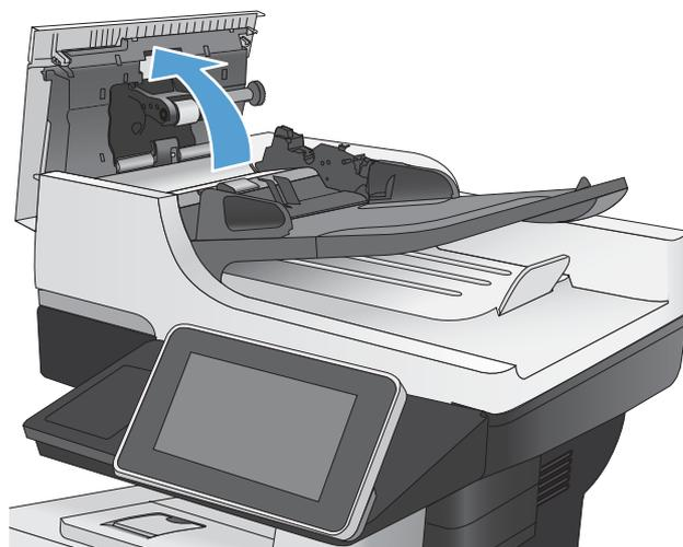
3. Ôtez tout résidu visible de fibres ou de poussière situé sur les rouleaux d'alimentation et la bande de séparation en insufflant de l'air comprimé ou au moyen d'un chiffon propre et non pelucheux imbibé d'eau chaude.
