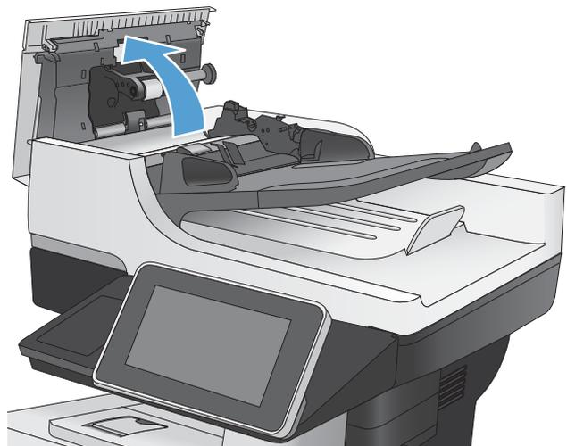
3. Ôtez tout résidu visible de fibres ou de poussière situé sur les rouleaux d'alimentation et la bande de séparation en insufflant de l'air comprimé ou au moyen d'un chiffon propre et non pelucheux imbibé d'eau chaude.
