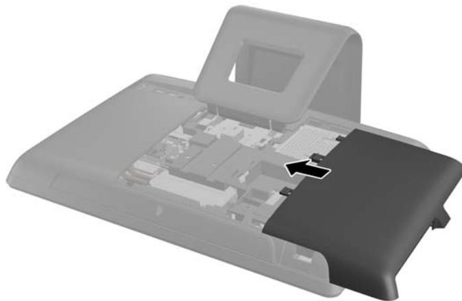
14. Faites pivoter le loquet du panneau d'accès au disque vers le haut et fermez-le pour maintenir le panneau en place.
