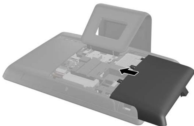
18. Faites pivoter le loquet du panneau d'accès au disque vers le haut et fermez-le pour maintenir le panneau en place.
