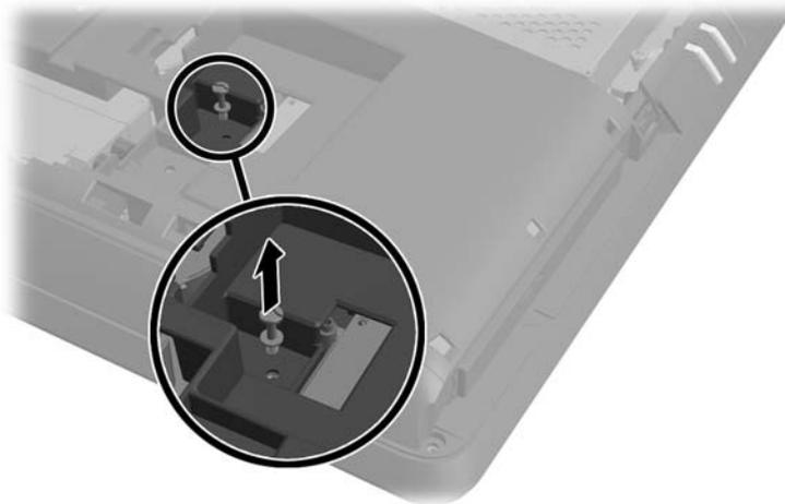
10. Avec vos doigts, appuyez sur l'arête visible du lecteur de disque optique en direction du côté de l'ordinateur pour le dégager partiellement de l'ordinateur. Saisissez l'avant du lecteur et retirez-le de l'ordinateur.
