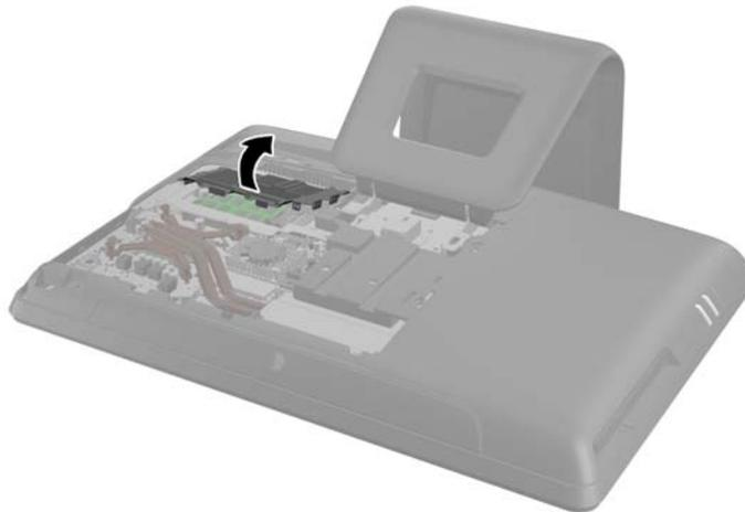
10. Si vous retirez un module de mémoire, poussez vers l'extérieur les deux loquets de chaque côté du module SODIMM (1), puis tirez sur le module SODIMM pour le retirer du support (2).
