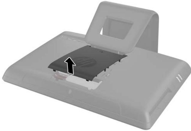
7. 打開固定磁碟機維修面板的門鎖。
