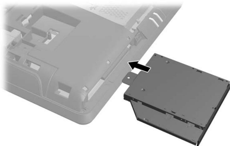
**12.** 鎖回螺絲，固定光碟機。
