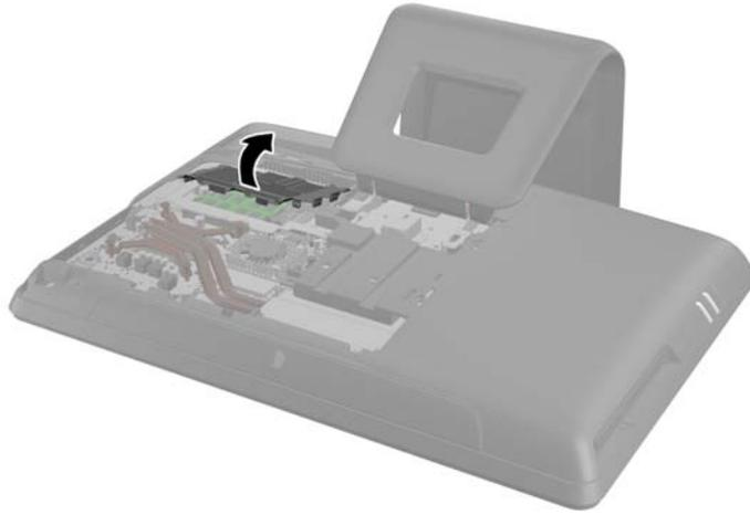
10. 如果您要卸下記憶體模組，請將位於 SODIMM 每一側的二個卡榫向外壓 (1)，然後將 SODIMM 從插槽拉出 (2)。
