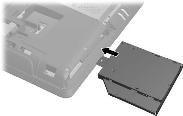
그림 2-40 광 디스크 드라이브 설치
