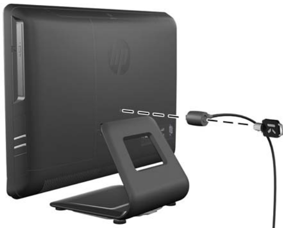
그림 2-44 보안 잠금 장치 설치
