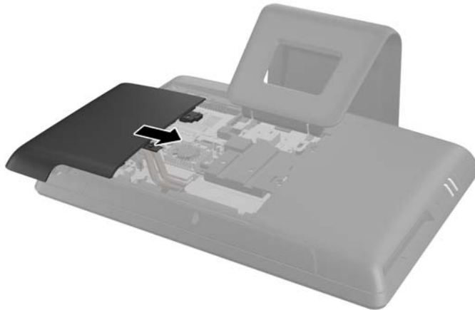
Figura 2-20 Reemplazo del panel de acceso de memoria
