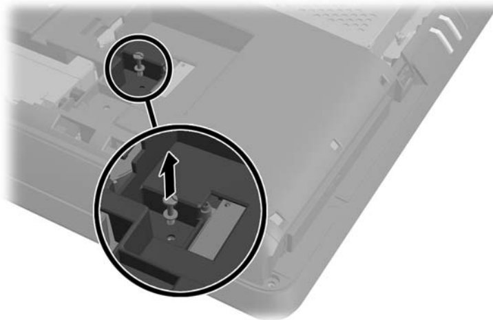
Figura 2-38 Extracción del tornillo de seguridad de la unidad de disco óptico
