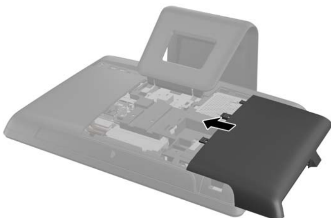
Figura 2-33 Reemplazo del panel de acceso de la unidad
