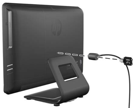
Figura 2-44 Instalación de un bloqueo de seguridad
