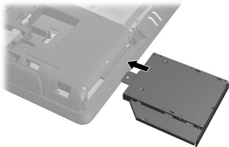
Figura 2-40 Instalación de la unidad de disco óptico
