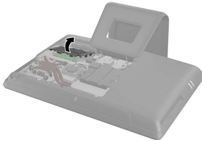
Figura 2-15 Extracción de la cubierta para memoria
