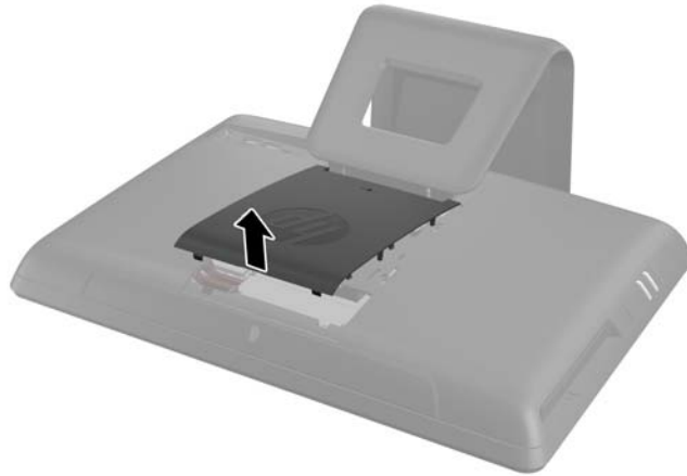
Figura 2-22 Extracción del panel de acceso central
