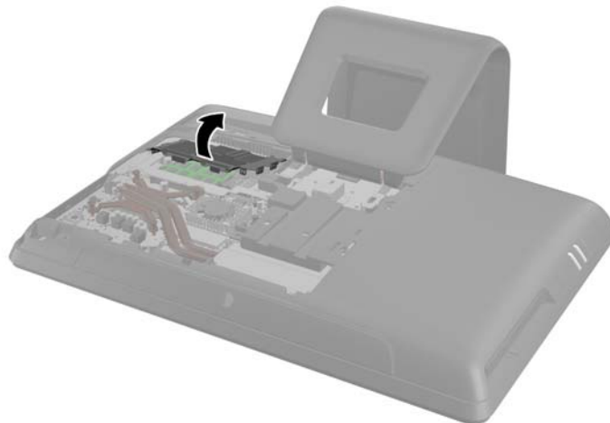
Figura 2-6 Extracción de la cubierta para memoria
