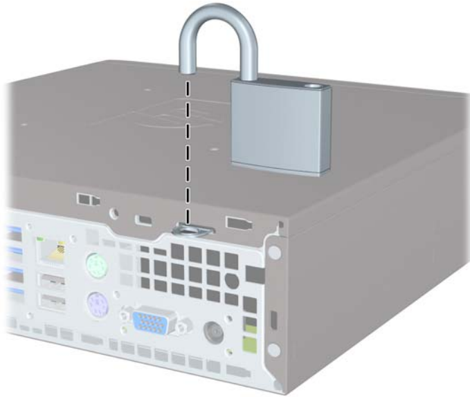
Abbildung 5-26 Anbringen eines Vorhängeschlosses
