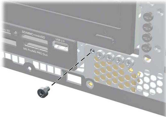
Abbildung 4-50 Entfernen der Sicherheitsschraube der Frontblende
