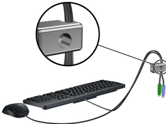
Abbildung 5-31 Führung der Tastatur- und Mauskabel
