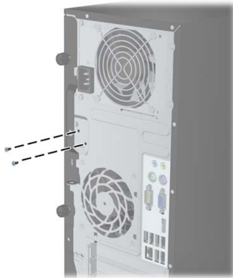
Abbildung C-2 Entfernen der Schrauben der Smart Cover-Sperre des Minitower
