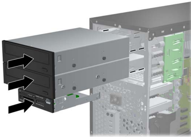
Abbildung 3-21 Hineinschieben des Laufwerks in den Laufwerkrahmen
