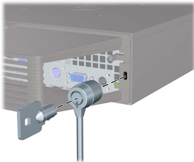
Abbildung 5-25 Anbringen einer Kabel-Diebstahlsicherung mit installierter Anschlussabdeckung
