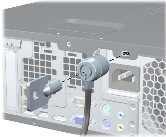
Abbildung 4-40 Anbringen einer Kabel-Diebstahlsicherung
