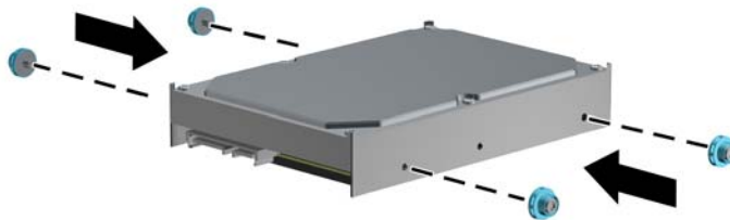
Abbildung 4-37 Anbringen der Festplattenführungsschrauben
