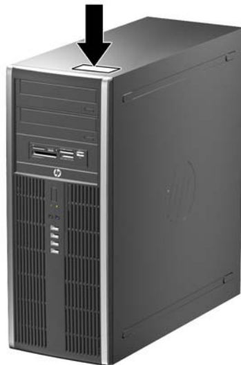
Abbildung 1-14 Position von Seriennummer und Produkt-ID des Convertible Minitower
