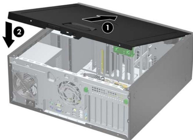
Figura 2-2 Riposizionamento del pannello di accesso al computer
