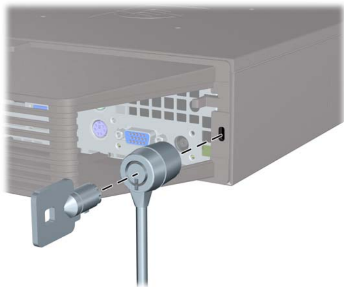
Figura 5-25 Installazione di un cavo con coperchio della porta installato
