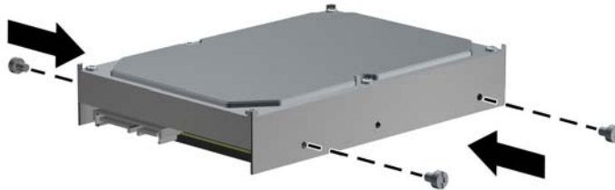
Figura 2-29 Installazione delle viti guida standard
