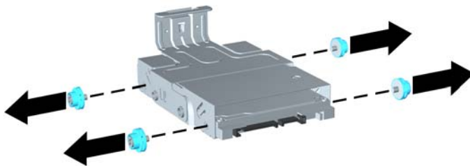
Figura 5-17 Rimozione delle viti guida
