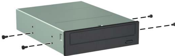
Figura 4-22 Installazione delle viti guida nell'unità ottica
