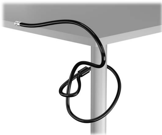
Figura 3-34 Installazione del cavo attorno un oggetto stabile
