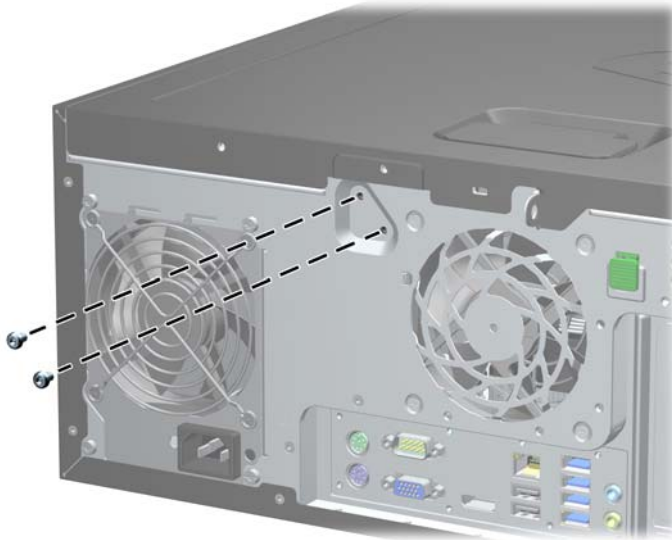
Figura C-2 Rimozione delle viti di blocco del coperchio dalla microtower
