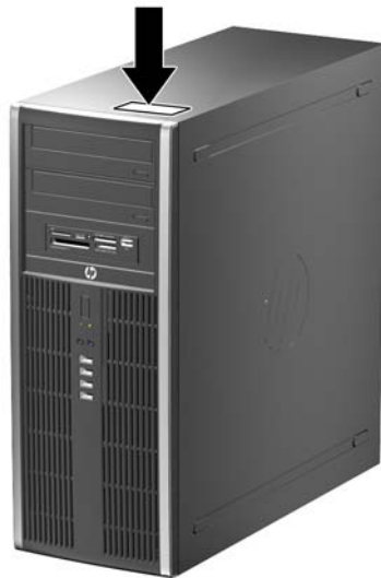
Figura 1-14 Posizione numero di serie e ID prodotto in Minitower convertibile
