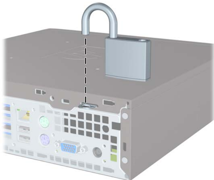
Figura 5-26 Installazione di un lucchetto
