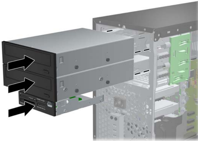
Figura 3-21 Inserimento dell'unità nell'alloggiamento
