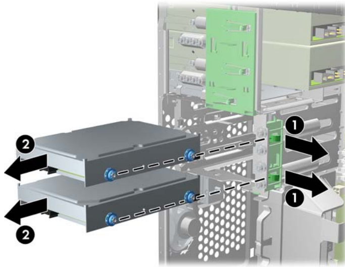
Figura 3-25 Rimozione di un'unità disco rigido
