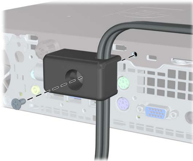
Figura 5-32 Fissaggio del fermo allo chassis
