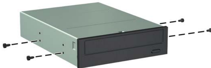
Figura 3-20 Installazione delle viti guida (in figura, unità ottica)
