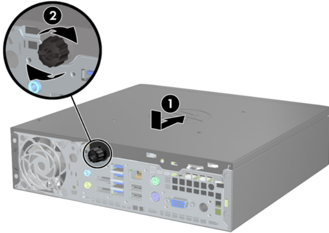
Figura 5-3 Reinstallazione del pannello di accesso al computer
