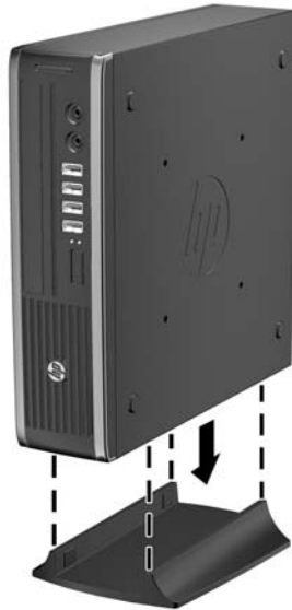
Figura 5-7 Inserire il computer nella base
