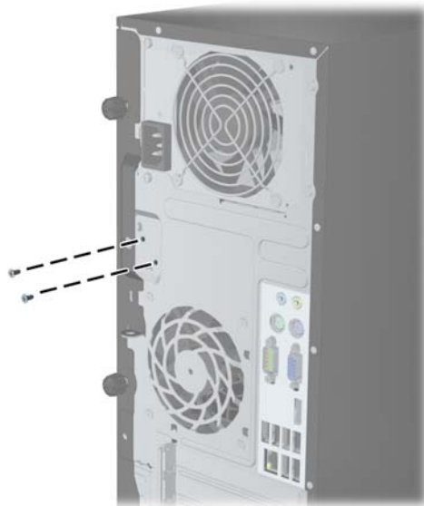
Figura C-2 Rimozione delle viti di blocco del coperchio dalla microtower
