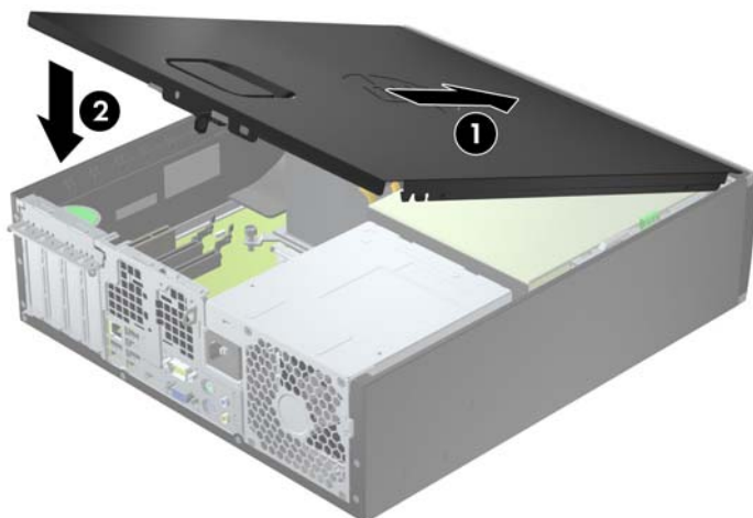
Figura 4-2 Riposizionamento del pannello di accesso al computer
