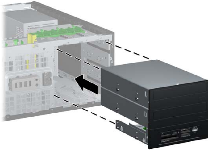
Figura 2-34 Installazione di un'unità nella configurazione desktop
