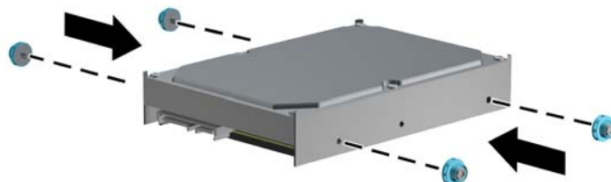
Figura 2-25 Installazione delle viti guida antivibrazione in un disco rigido da 3,5"
