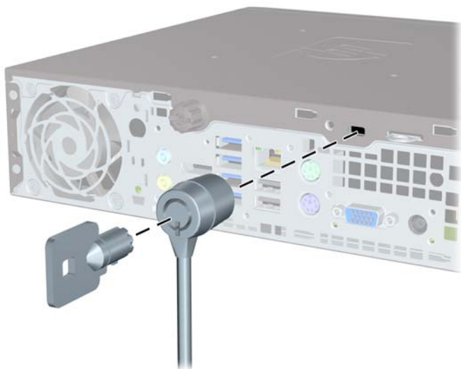
Figura 5-25 Installazione di un cavo con coperchio della porta installato
