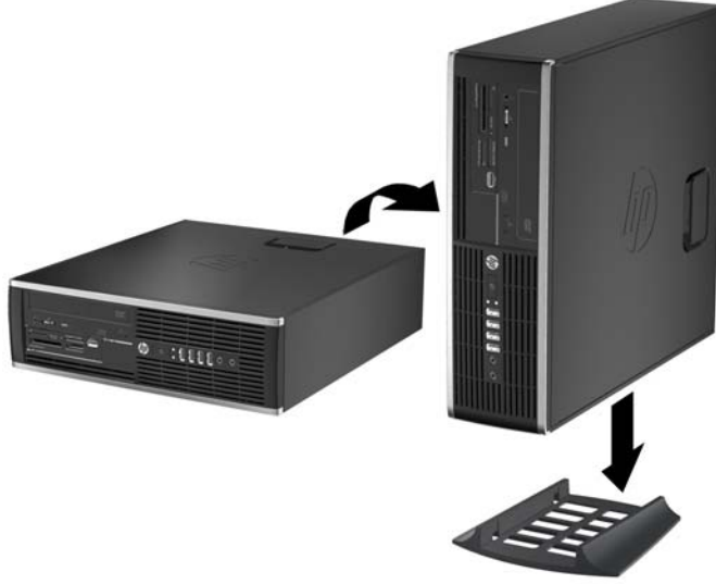
Şekil 4-6 Masaüstünden Kasa Yönüne Geçme
