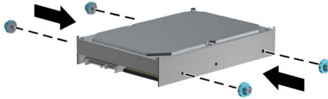
Şekil 2-25 3,5 inçlik Sabit Sürücüye Yalıtım Sabitleme Kılavuz Vidalarını Takma
