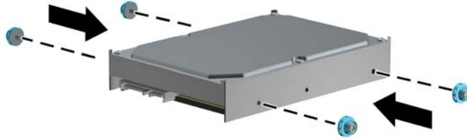
Şekil 3-26 3,5 inçlik Sürücüye Yalıtım Sabitleme Kılavuz Vidalarını Takma
