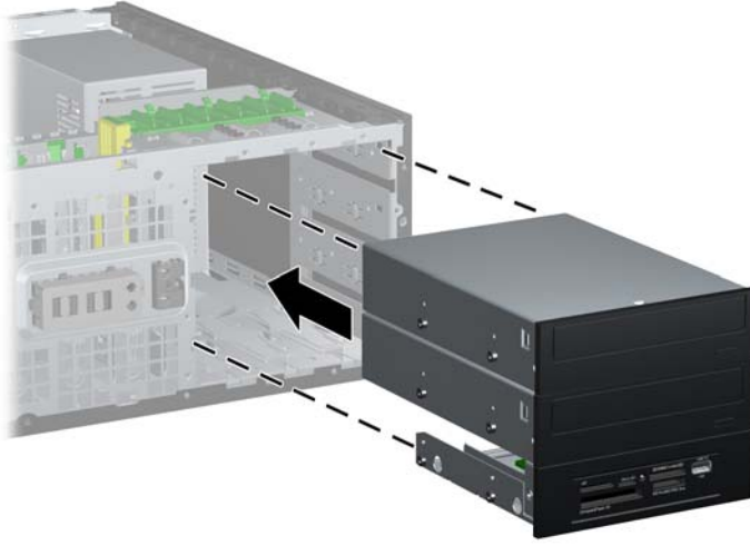
Şekil 2-34 Masaüstü Yapılandırmasında Sürücü Takma
