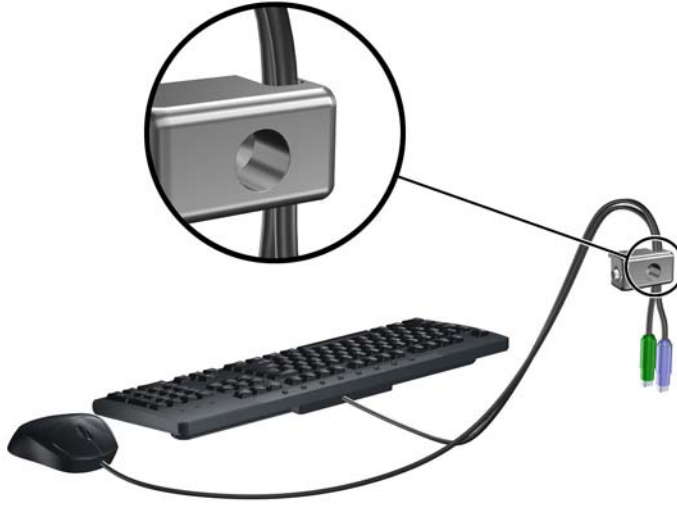
Şekil 3-38 Klavye ve Fare Kablolarını Kilitten Geçirme
