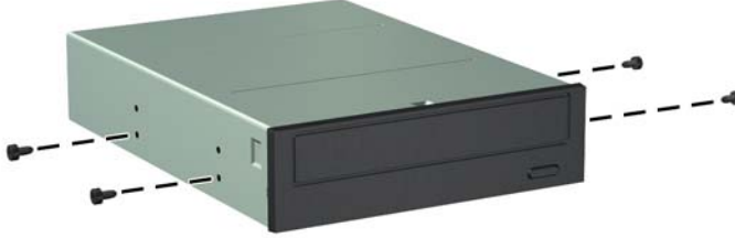
Şekil 3-20 Kılavuz Vidaları Takma (Optik Sürücü Gösterilmiştir)
