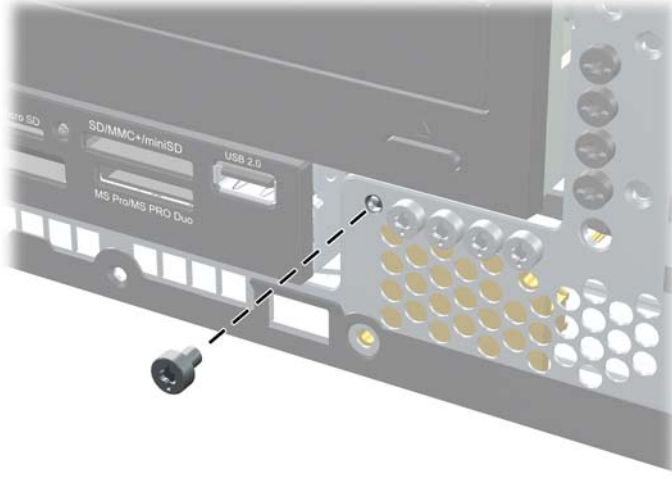
Şekil 4-50 Ön Çerçeve Sabitleme Vidasının Alınması
