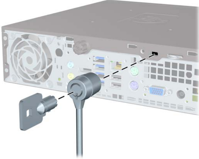
Şekil 5-25 Bağlantı Noktası Kapağı Takılı Olarak Kablo Takma
