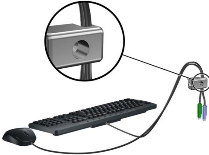
Şekil 2-45 Klavye ve Fare Kablolarını Kilitten Geçirme
