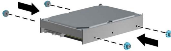
Şekil 4-37 Sabit Sürücü Kılavuz Vidaları Takma
