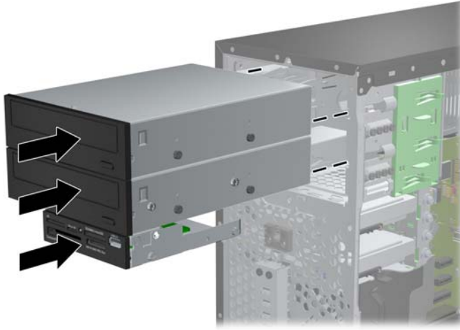
Şekil 3-21 Sürücüleri Kaydırarak Sürücü Kafesine Yerleştirme
