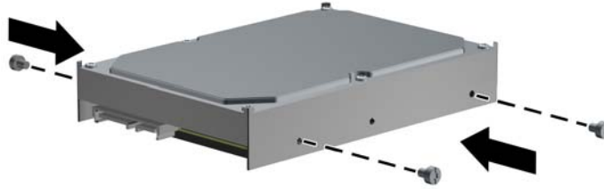
Şekil 2-29 Standart Kılavuz Vidaları Takma
