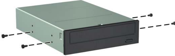
Şekil 4-22 Kılavuz Vidaların Optik Sürücüye Takılması
