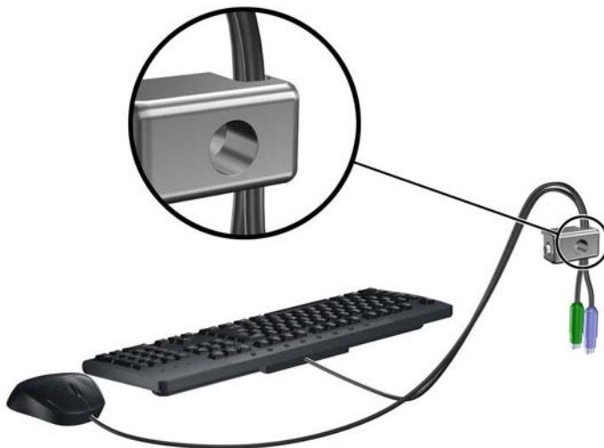
Εικόνα 4-46 Ασφάλιση καλωδίων πληκτρολογίου και ποντικιού
