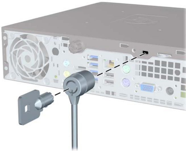
Εικόνα 5-24 Τοποθέτηση κλειδαριάς καλωδίου χωρίς κάλυμμα θύρας
