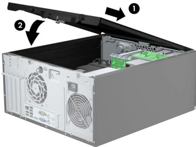
Εικόνα 3-2 Επανατοποθέτηση του καλύμματος πρόσβασης του υπολογιστή
