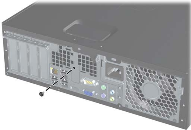
Εικόνα Γ-3 Αφαίρεση των βιδών ασφάλισης Smart Cover από τον υπολογιστή μικρών διαστάσεων
