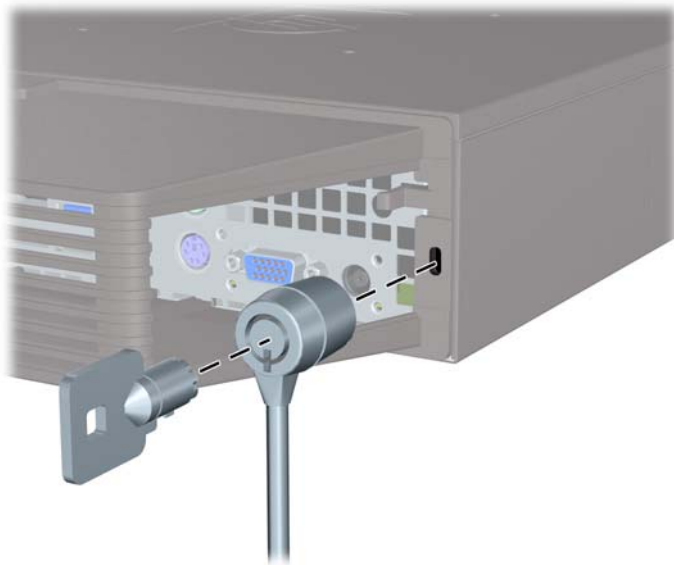
Εικόνα 5-25 Τοποθέτηση καλωδίου με τοποθετημένο κάλυμμα θύρας
