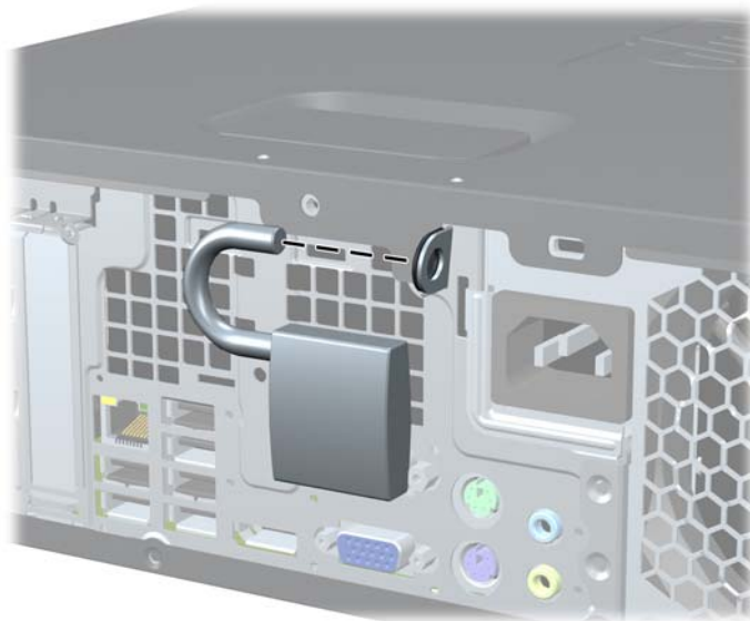
Obrázek 4-41 Instalace visacího zámku
