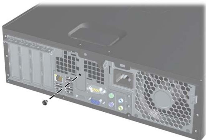
Obrázek C-3 Odšroubování šroubů chytrého zámku krytu z modelu Small Form Factor
