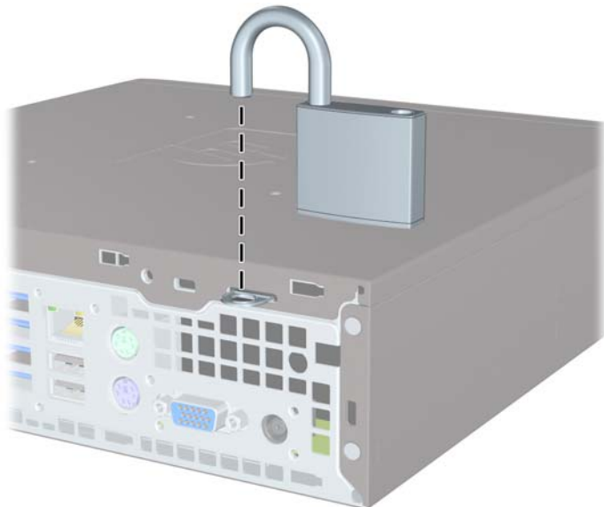
Obrázek 5-26 Instalace visacího zámku
