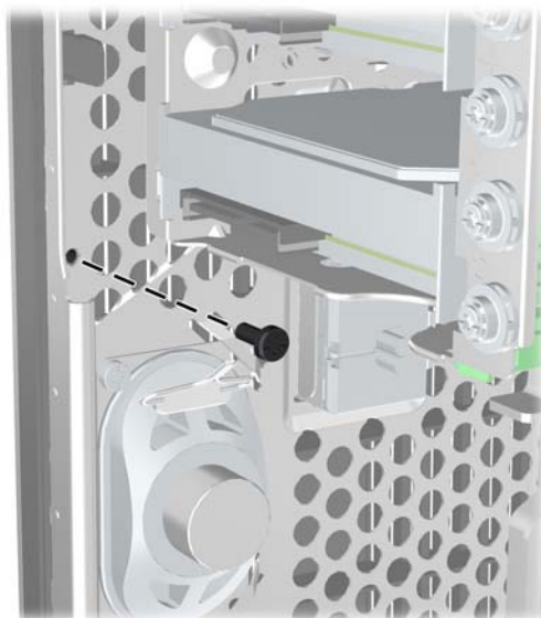
Obrázek 3-43 Instalace bezpečnostního šroubu čelního panelu
