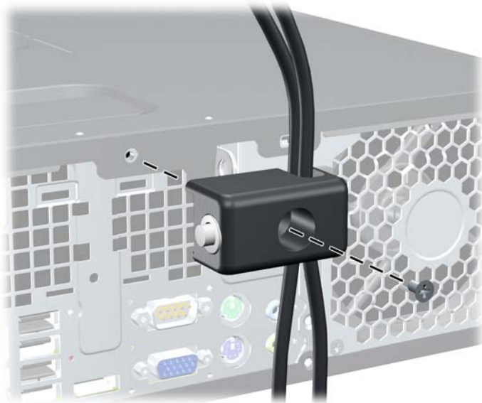
Obrázek 4-47 Připevnění zámku ke skříni
