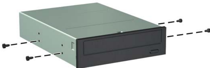
Obrázek 4-22 Zašroubování vodicích šroubů do optické jednotky
