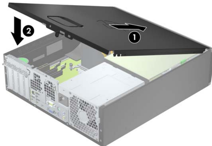
Obrázek 4-2 Nasazení krytu počítače
