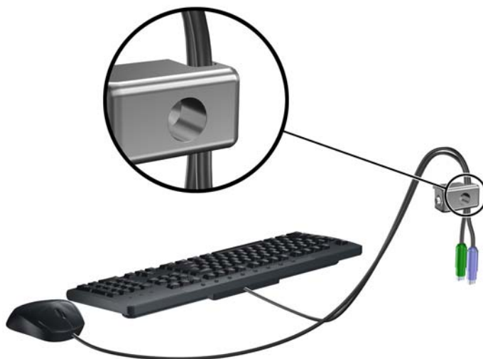
Obrázek 3-38 Protážení kabelů klávesnice a myši
