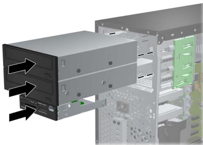
Obrázek 3-21 Zasunutí jednotky do modulu jednotek
