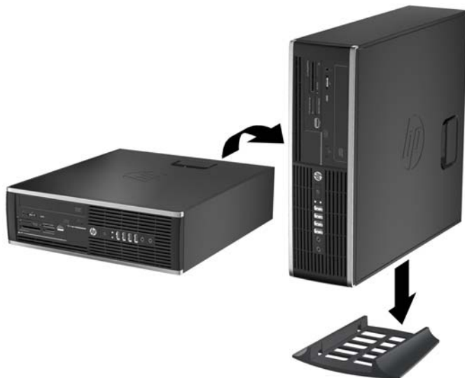
Obrázek 4-6 Změna orientace stolního počítače na typ tower
