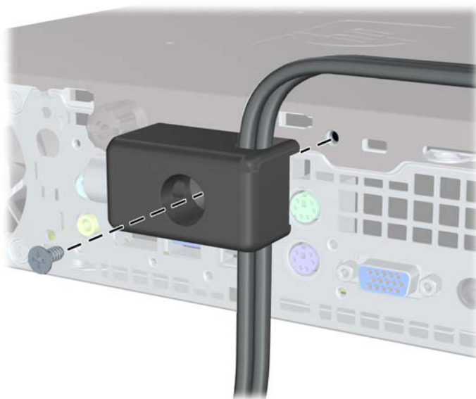
Obrázek 5-32 Připevnění zámku ke skříni
