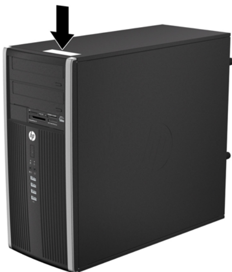
Фигура 1-16 Местоположение на серийния номер и продуктивния идентификатор при модел с малки размери
