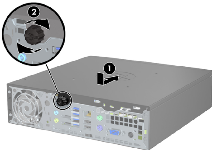
Фигура 5-3 Смяна на панела за достъп до компютъра
