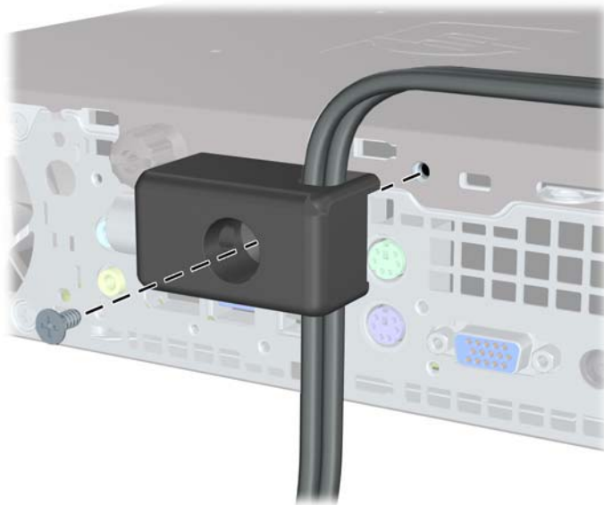
Фигура 5-32 Закрепване на фиксатора към шасито
