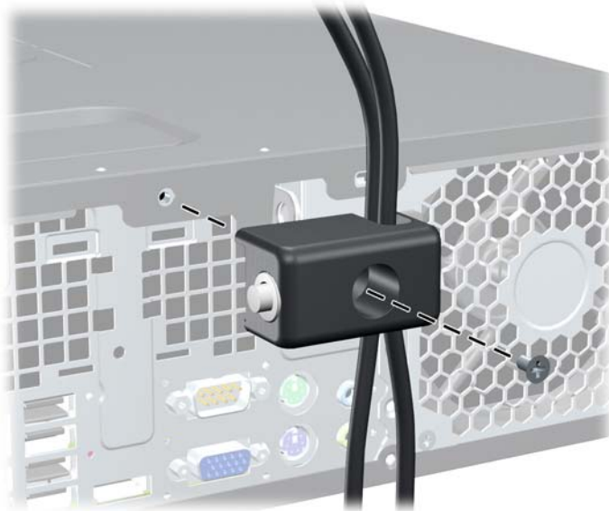
Фигура 4-47 Закрепване на фиксатора към шасито
