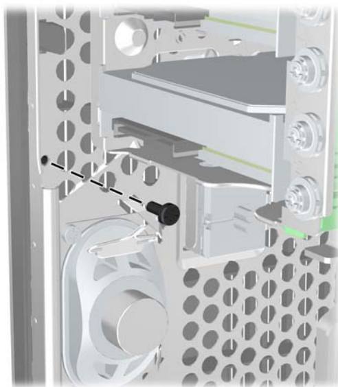
Фигура 3-43 Поставяне на защитния винт на лицевия панел
