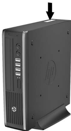
Фигура 1-17 Местоположение на серийния номер и продуктивния идентификатор при свръхтънък настолен модел (USDT)
