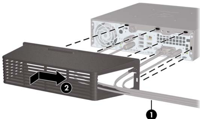
Figura 5-22 Instalarea capacului de port
