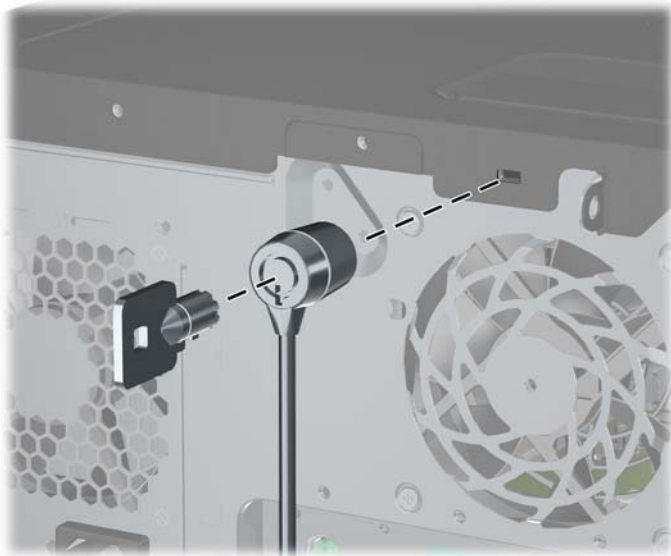
Figura 2-39 Instalarea unui dispozitiv de blocare cu cablu
