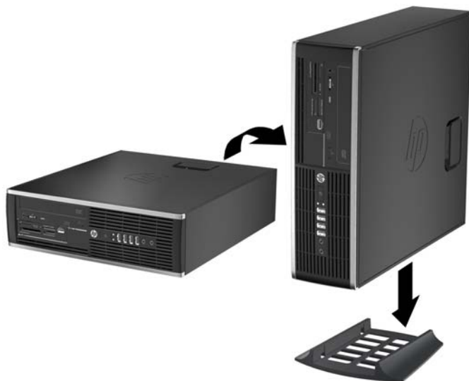
Figura 4-6 Schimbarea din configurație de computer de birou în configurație turn
