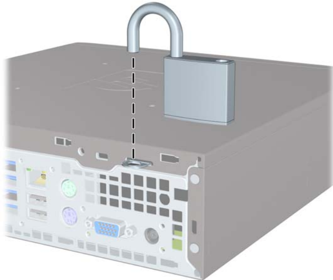
Figura 5-26 Instalarea unui lacăt
