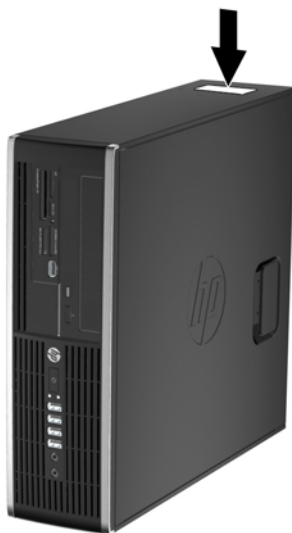
Figura 1-16 Amplasările pentru numărul serial al Small Form Factor și pentru numărul de identificare a produsului
