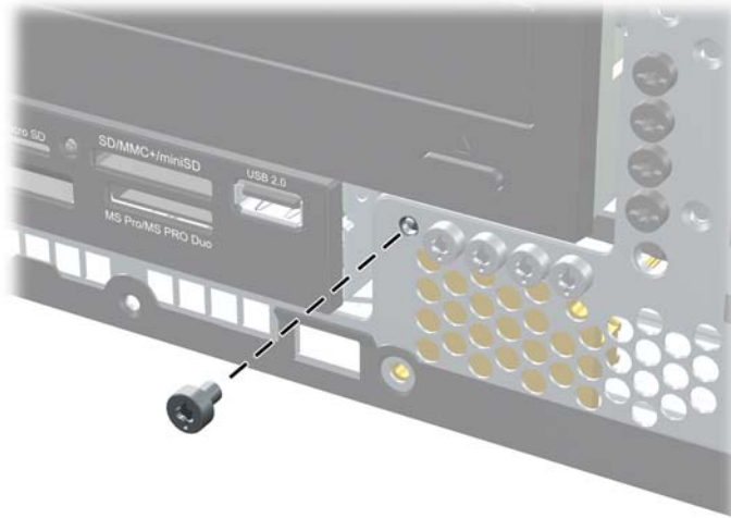
Figura 4-50 Recuperarea șurubului de siguranță de la masca frontală
