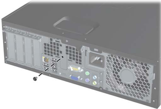
Figura C-3 Îndepărtarea șuruburilor de reținere inteligentă a capacului de la Smart Form Factor
