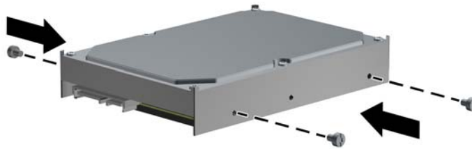
Figura 2-29 Instalarea șuruburilor de ghidare standard
