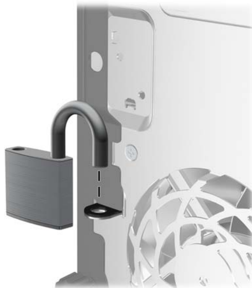
Figura 3-33 Instalarea unui lacăt
