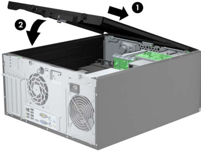
Figura 3-2 Montarea panoului de acces în computer
