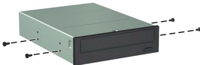
Figura 4-22 Instalarea șuruburilor pentru ghid în unitatea optică
