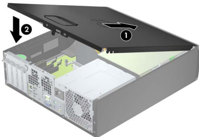
Figura 4-2 Montarea panoului de acces în computer
