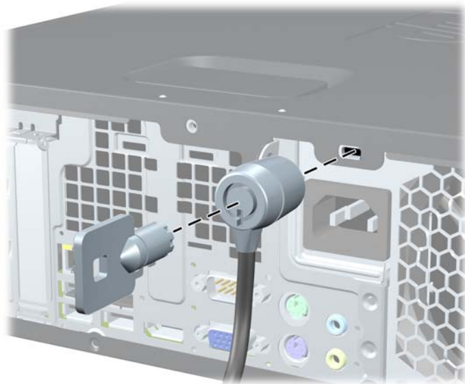
Figura 4-40 Instalarea unui dispozitiv de blocare cu cablu
