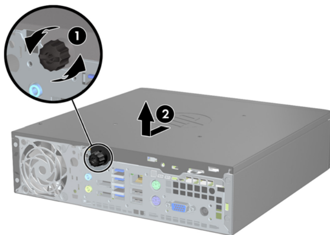
Figura 5-2 Scoaterea panoului de acces în computer
