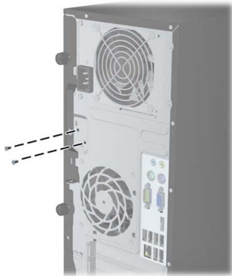
Figura C-2 Îndepărtarea șuruburilor de reținere inteligentă a capacului de la miniturn
