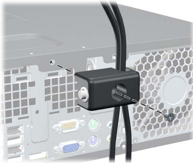
Figura 4-47 Atașarea dispozitivului de blocare la șasiu
