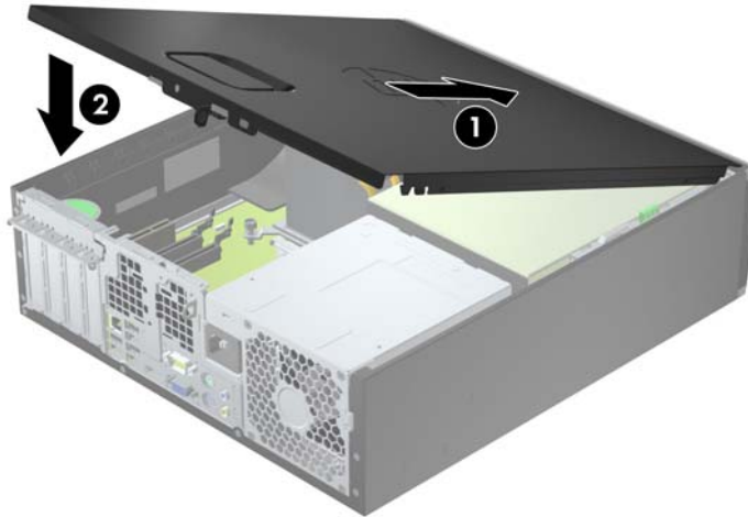
ภาพ 4-2 การใส่แผงปิดเครื่องคอมพิวเตอร์กลับเข้าที่
