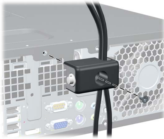
ภาพ 4-47 การใส่ล็อกกับเครื่องโครงเครื่อง
