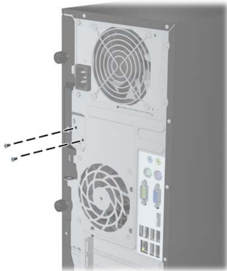
ภาพ C-2 การถอดสกรูล็อค Smart Cover Lock ออกจาก Minitower
