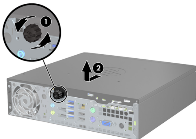
ภาพ 5-2 การถอดแฉงปิดเครื่องคอมพิวเตอร์
