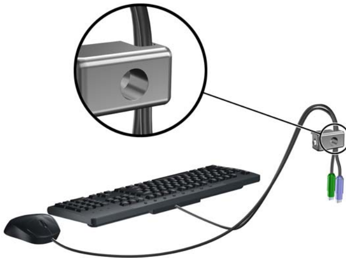
ภาพ 5-31 การสอดสายเคเบิลของแป้นพิมพ์และเมาส์
