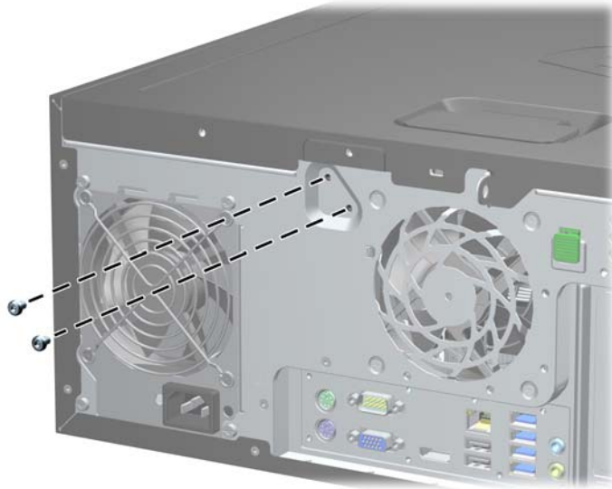
ภาพ C-2 การถอดสกรูล็อค Smart Cover Lock ออกจาก Minitower
