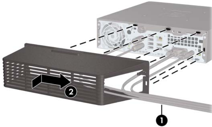
ภาพ 5-22 การติดตั้งฝาปิดพอร์ต
