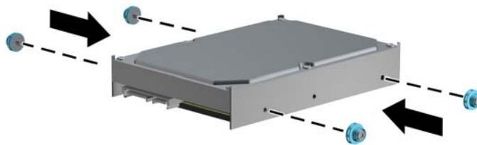
ภาพ 3-26 การติดตั้งสกรูตัวนำแบบติดตั้งแยกต่างหากในไดรฟ์ขนาด 3.5 นิ้ว
