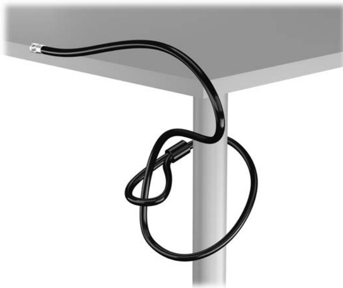
ภาพ 3-34 การยึดสายเคเบิลไว้กับวัตถุที่แน่นอน
