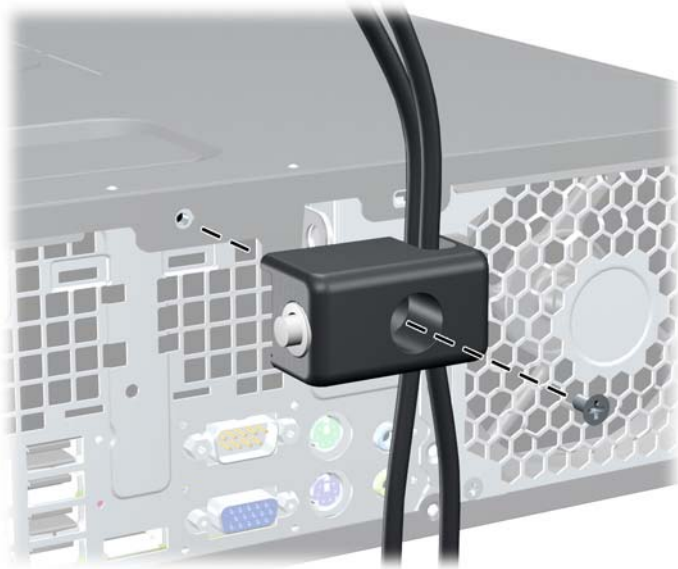
图 4-47 将钳锁固定到机箱上
