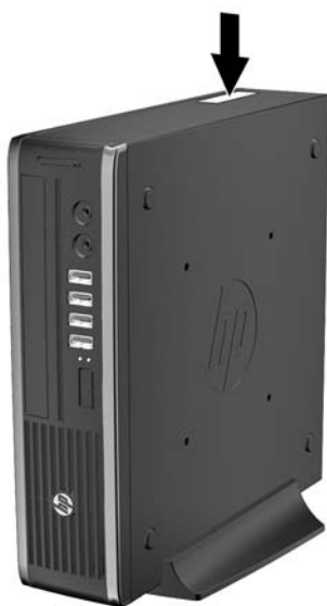
图 1-17 超薄台式机 (USDT) 序列号和产品 ID 的位置
