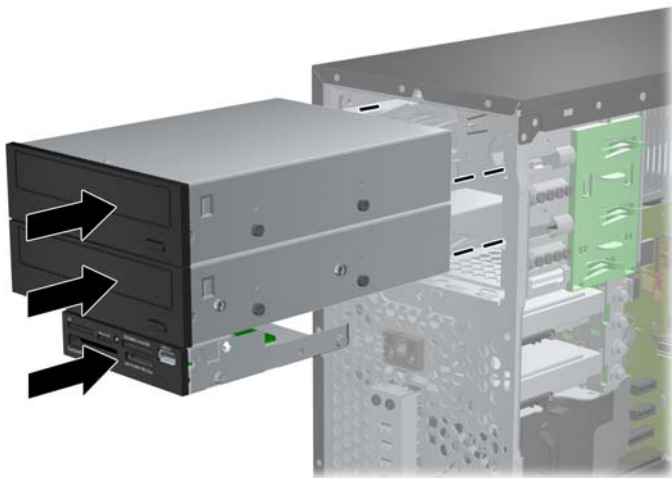
图 3-21 将驱动器滑入驱动器框架
