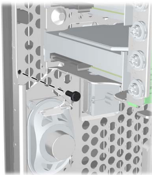
图 3-43 安装前面板安全保护螺钉
