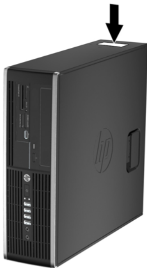
图 1-17 超薄台式机 (USDT) 序列号和产品 ID 的位置
