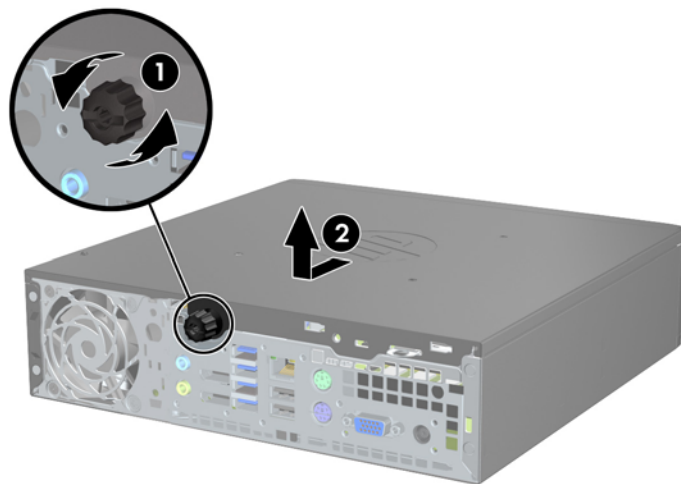
图 5-2 卸下计算机检修面板
