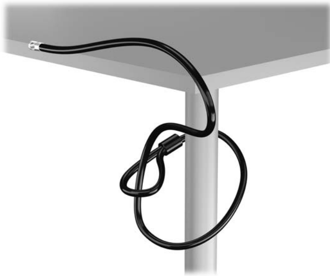
图 3-34 将缆锁固定在稳固的物体上
