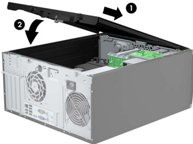
图 3-2 重新装上计算机检修面板
