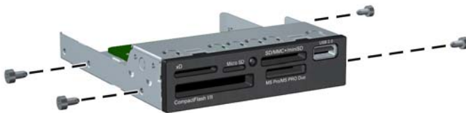
图 4-29 安装导向螺钉（所示为介质卡读卡器）
