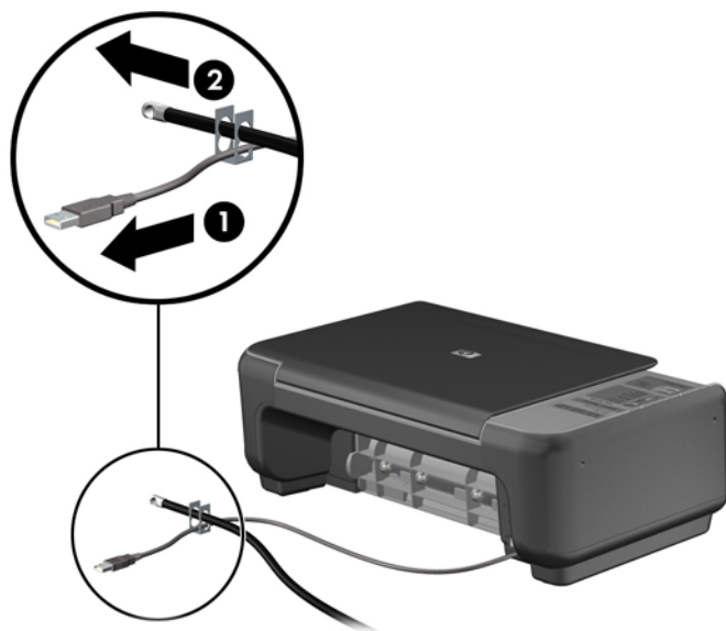
图 4-45 固定外设（所示为打印机）
