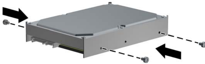
图 2-29 安装标准导向螺钉
