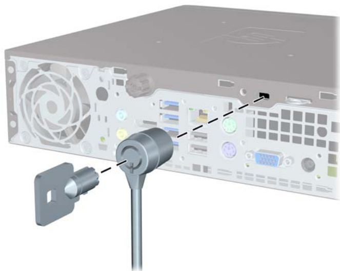
图 5-25 已安装端口盖时安装缆锁
