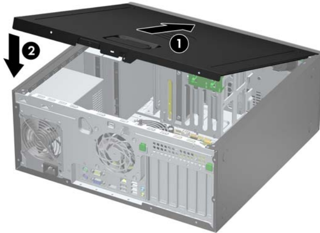
图 2-2 重新装上计算机检修面板
