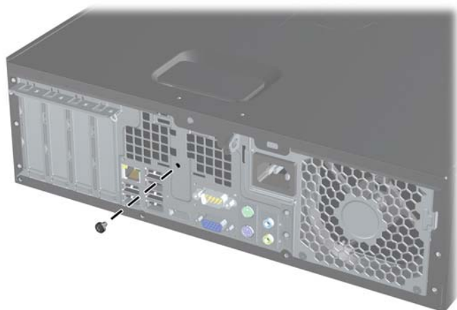
图 C-3 卸下薄型卧式纤小机型的智能锁扣螺钉
