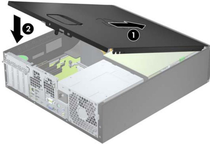
图 4-2 重新装上计算机检修面板
