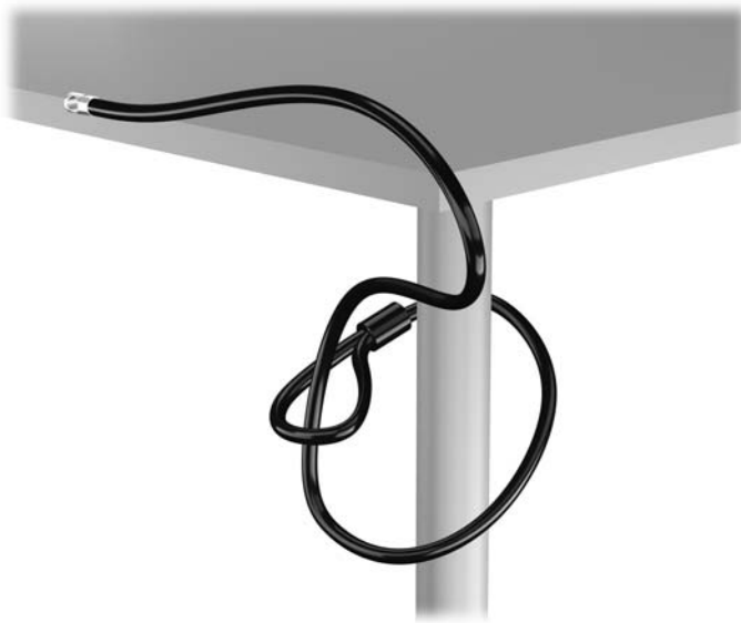
圖示 3-34 將纜線固定在固定物體上
