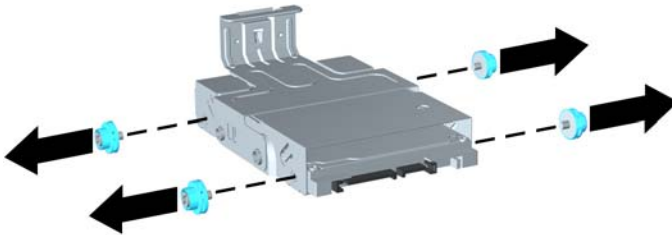
圖示 5-17 拆下導引螺絲
