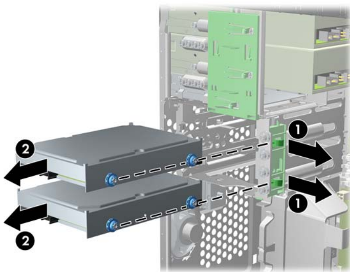
圖示 3-25 拆下硬碟機
