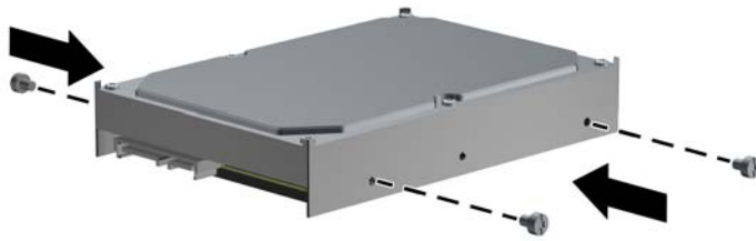
圖示 2-29 安裝標準導引螺絲
