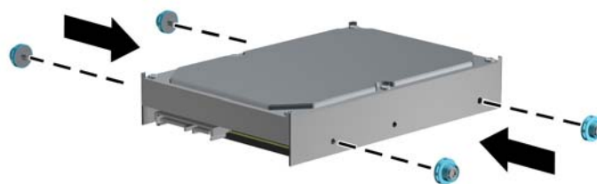
圖示 4-37 安裝硬碟機導引螺絲
