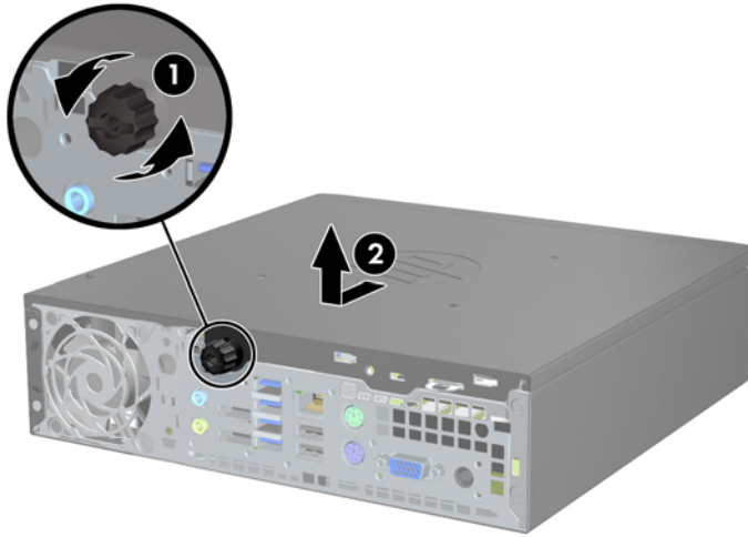
圖示 5-2 拆下電腦存取面板
