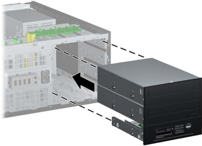
圖示 2-34 在桌上型電腦配置下安裝磁碟機
