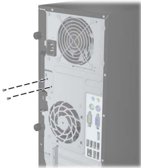
圖示 C-2 從迷你直立型電腦拆下智慧型外蓋安全鎖螺絲
