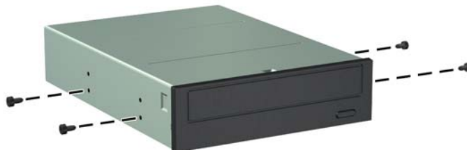
圖示 4-22 將導引螺絲安裝到光碟機中
