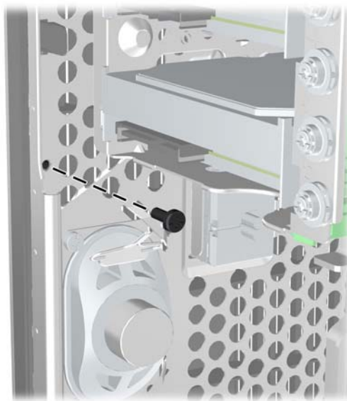
圖示 3-43 安裝前面板安全螺絲
