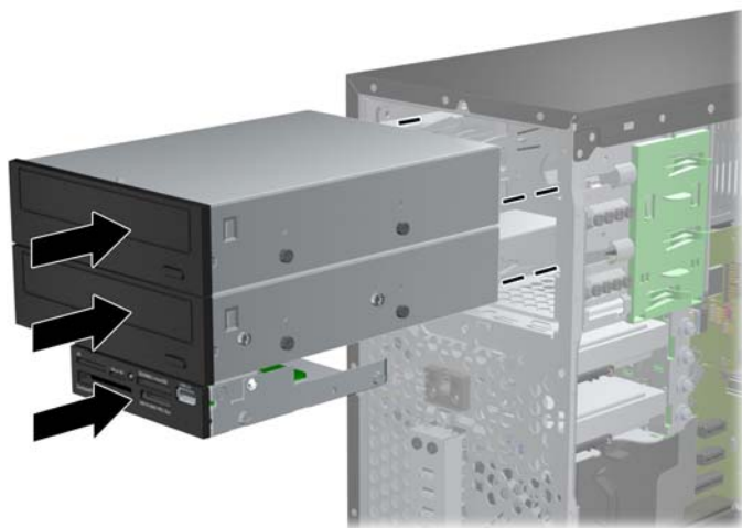
圖示 3-21 將磁碟機推入磁碟機座
