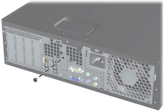
圖示 C-3 從迷你桌上型電腦拆下智慧型外蓋安全鎖螺絲
