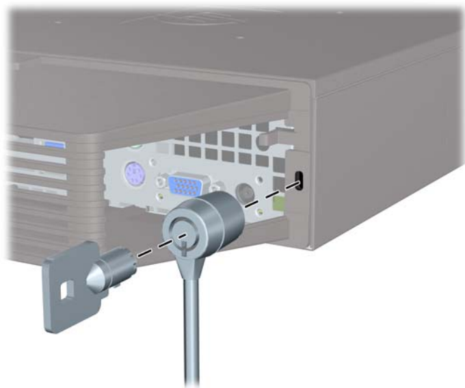
圖示 5-25 已安裝連接埠外蓋時安裝纜線
