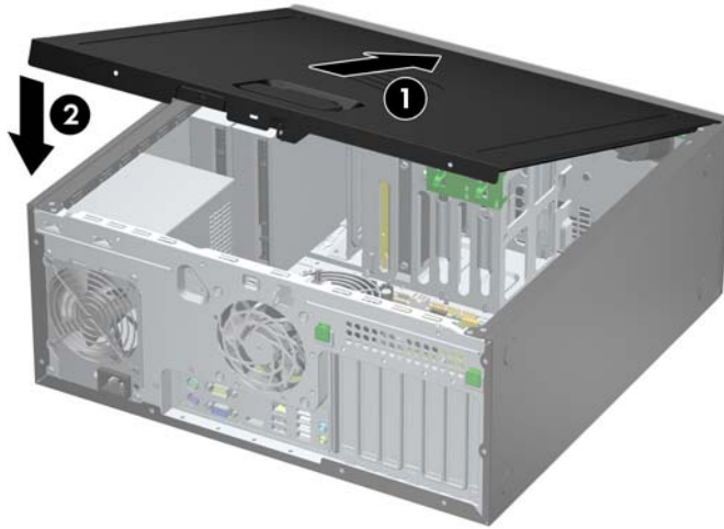
圖示 2-2 裝回電腦存取面板
