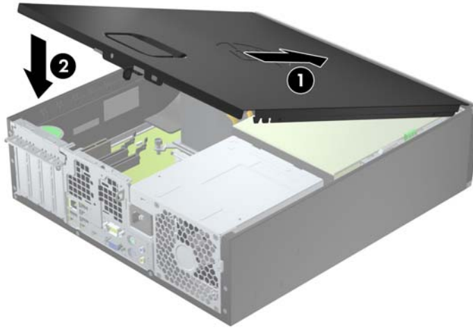
圖示 4-2 裝回電腦存取面板
