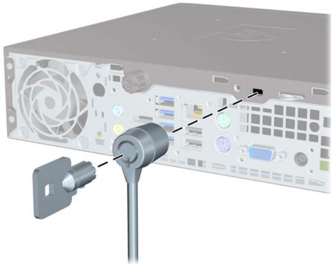
圖示 5-25 已安裝連接埠外蓋時安裝纜線
