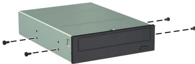
圖示 3-20 鎖入導引螺絲（所示為光碟機）
