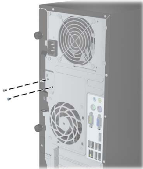
그림 C-2 마이크로타워의 스마트 덮개 잠금 나사 분리
