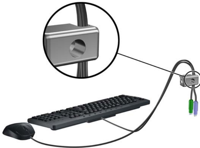
그림 5-31 키보드 및 마우스 케이블 모아 넣기
