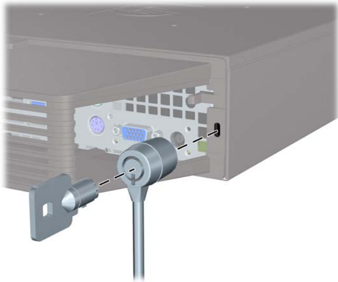
그림 5-25 포트 덮개가 있는 경우 케이블 설치
