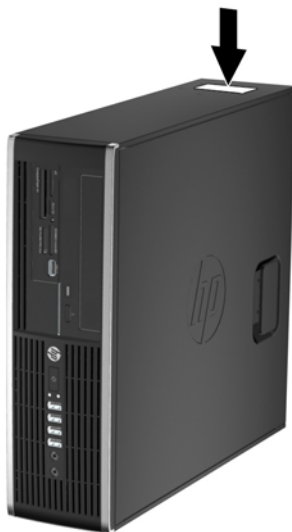
그림 1-16 소형 폼 팩터 일련 번호 및 제품 ID 위치
