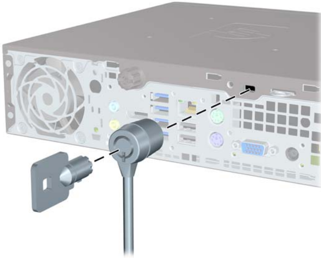
그림 5-25 포트 덮개가 있는 경우 케이블 설치
