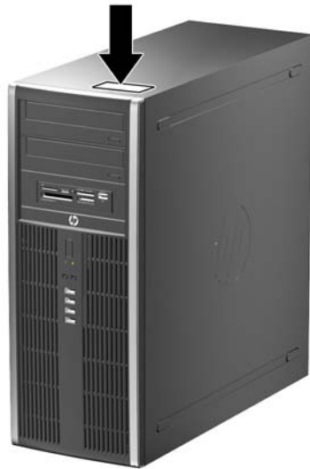
그림 1-14 컨버터블 미니타워 일련 번호 및 제품 ID 위치
