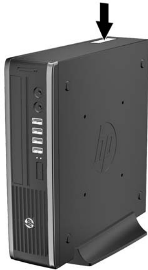
그림 1-17 USDT(울트라 슬림 데스크탑) 일련 번호 및 제품 ID 위치
