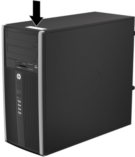
그림 1-16 소형 폼 팩터 일련 번호 및 제품 ID 위치
