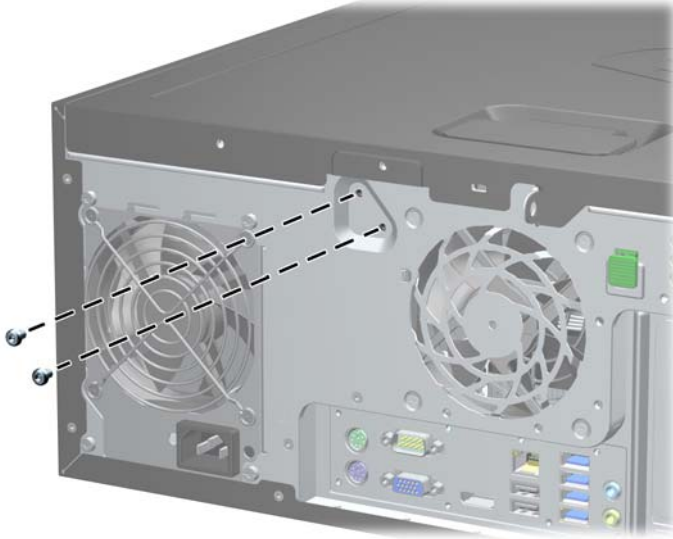
그림 C-2 마이크로타워의 스마트 덮개 잠금 나사 분리
