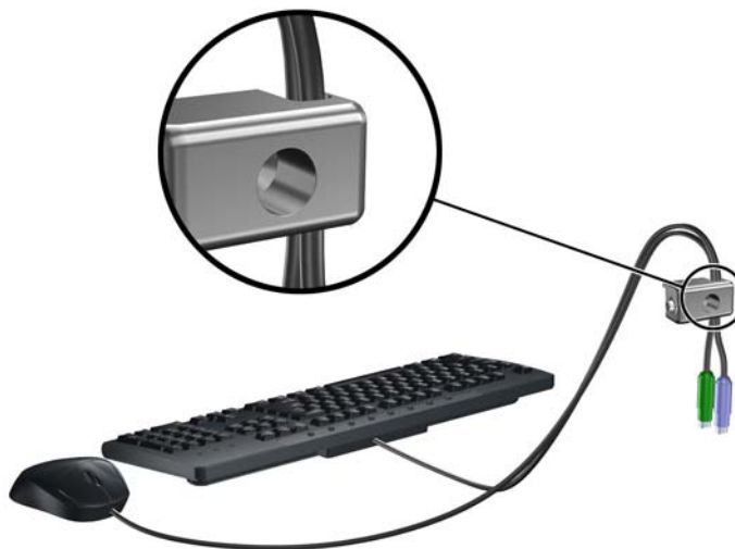
Slika 2-45 Napeljava kabla tipkovnice in miške
