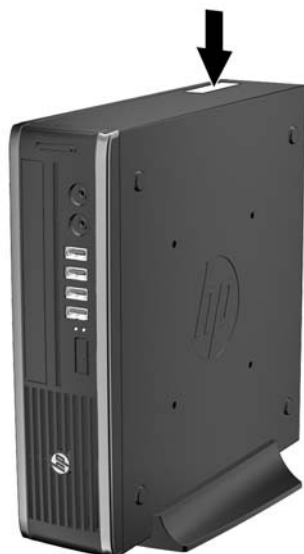
Slika 1-17 Mesto serijske številke in identifikacijske številke ultratankega namiznega ohišja (USDT)
