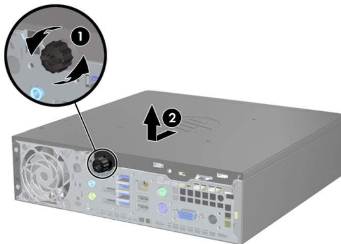
Slika 5-2 Odstranitev pokrova računalnika
