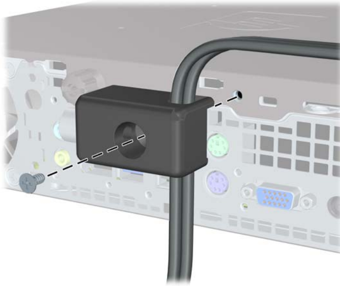
Slika 5-32 Pritrditev ključavnice na ohišje
