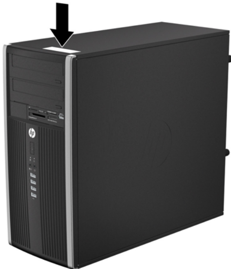
Slika 1-16 Mesto serijske številke in identifikacijske številke ohišja majhne velikosti
