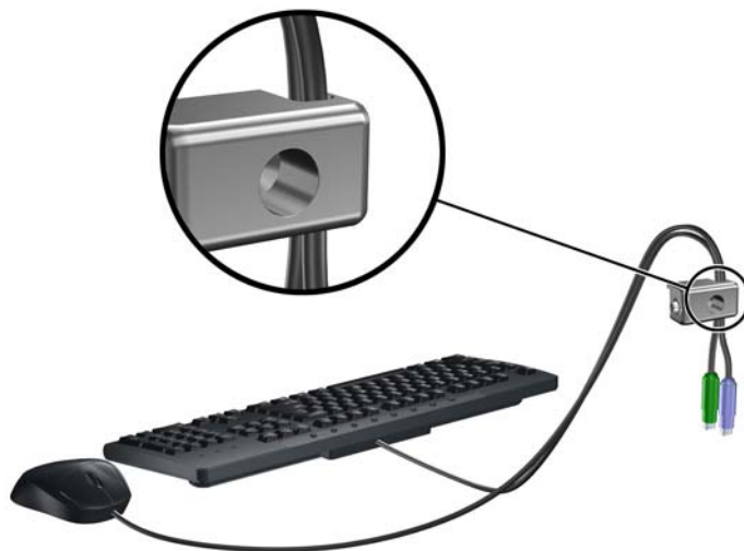
Slika 5-31 Napeljava kablov tipkovnice in miške
