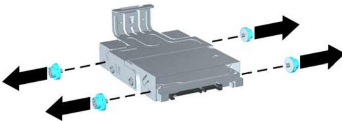
Slika 5-17 Odstranitev vodilnih vijakov
