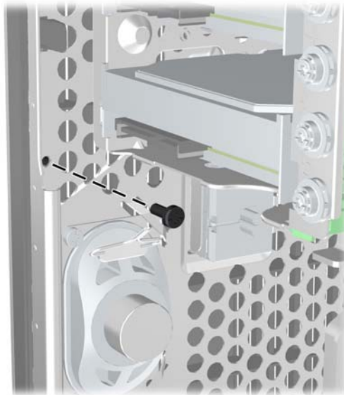
Slika 3-43 Nameščanje varnostnega vijaka sprednje plošče
