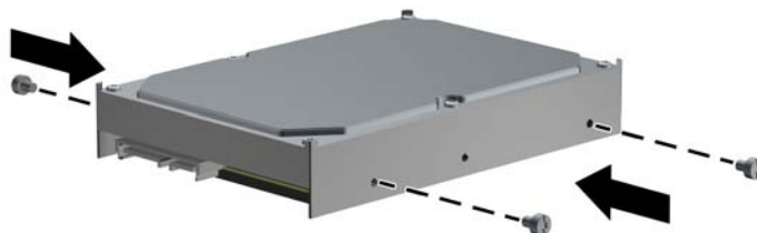
Slika 2-29 Nameščanje standardnih vodilnih vijakov
