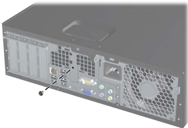
Slika C-3 Odstranjevanje vijakov pametne ključavnice pokrova z ohišja majhne velikosti
