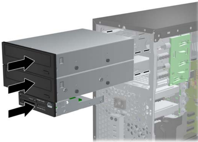
Slika 3-21 Potiskanje pogonov v kletko za pogon
