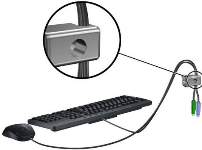
Slika 3-38 Napeljava kabla tipkovnice in miške
