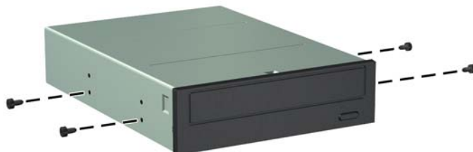
Slika 4-22 Nameščanje vodilnih vijakov na optični pogon
