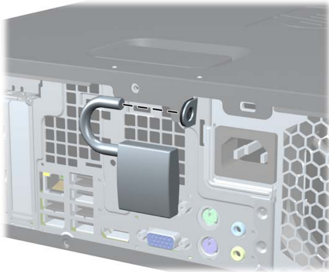
Slika 4-41 Ugradnja sigurnosnog lokota
