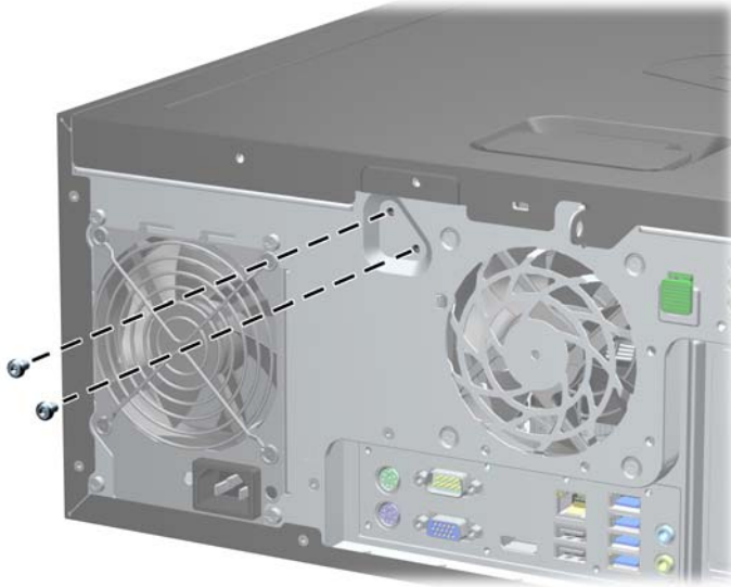
Slika C-2 Uklanjanje Smart Cover Lock vijaka s računala Microtower
