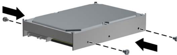
Slika 2-29 Ugradnja standardnih vijaka
