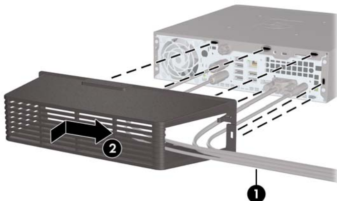
Slika 5-22 Ugradnja poklopca priključnice
