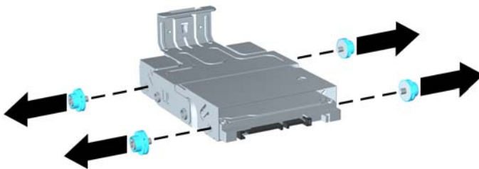
Рисунок 5-17 Витягання направляючих гвинтів
