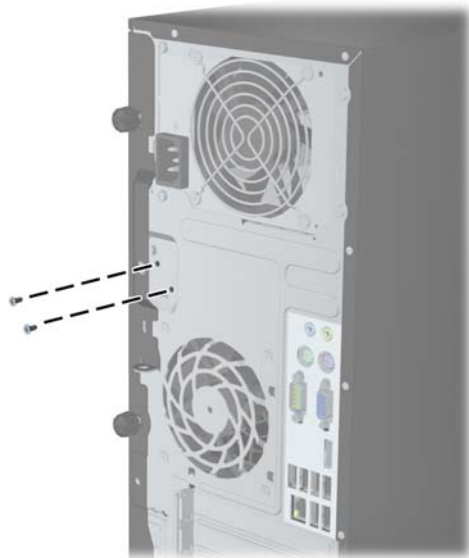
Рисунок в-2 Зняття гвинтів замку корпусу з Microtower
