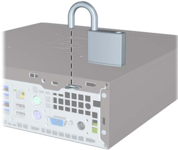
Рисунок 5-26 Встановлення висячого замка
