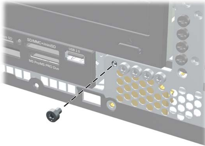
Рисунок 4-50 Виймання захисного гвинта фальш-панелі
