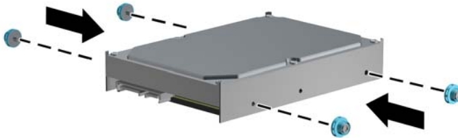
Рисунок 4-37 Встановлення направляючих гвинтів жорсткого диска
