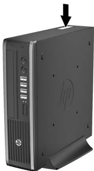
Рисунок 1-17 Розміщення серійного номера й ідентифікаційного коду виробу на компактній настільній моделі
