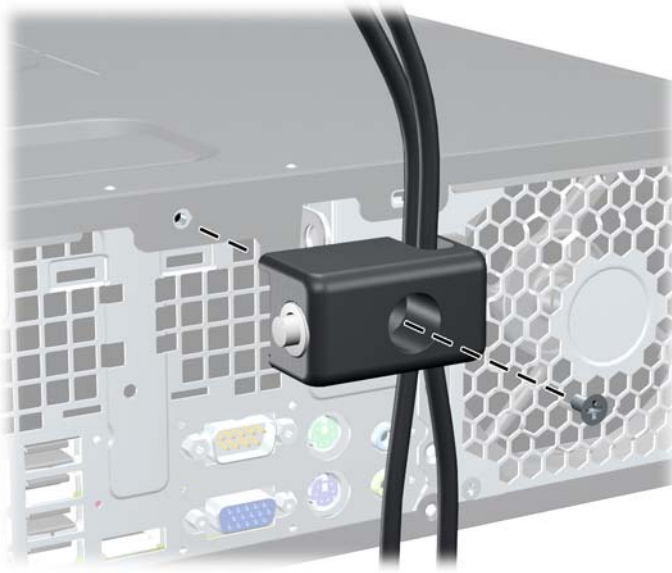
Рисунок 4-47 Приєднання фіксатора до корпусу
