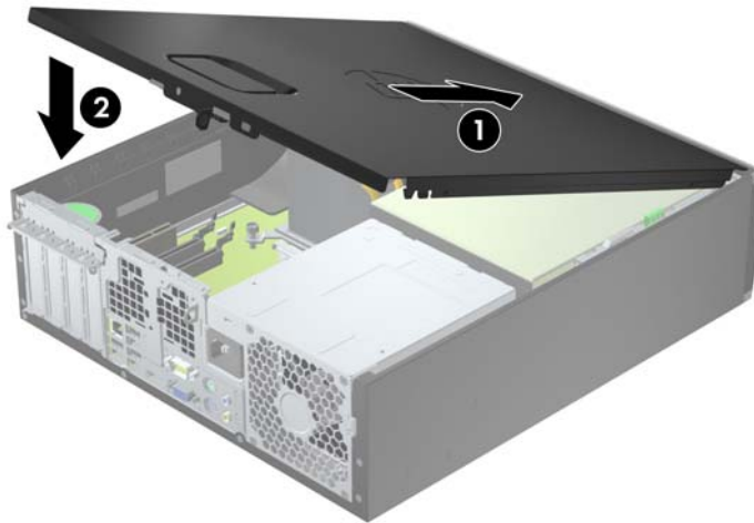
Рисунок 4-2 Встановлення знімної панелі комп'ютера
