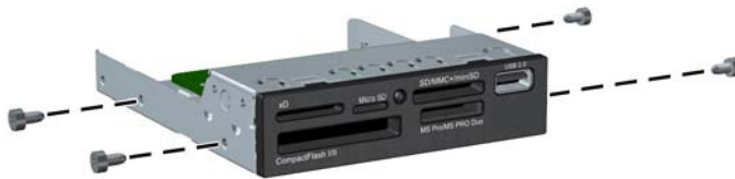
Gambar 4-29 Memasang Sekrup Panduan (Pembaca Kartu Media Ditampilkan)
