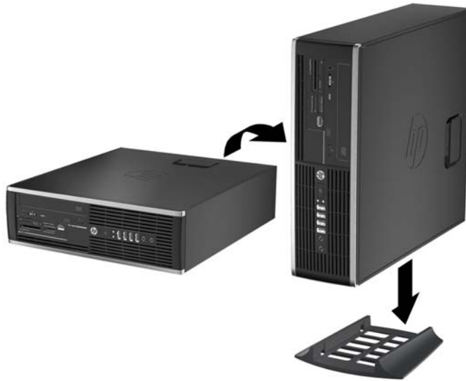
Gambar 4-6 Mengubah dari Posisi Horizontal ke Vertikal
