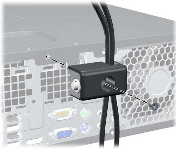
Gambar 4-47 Memasang Kunci pada Chassis
