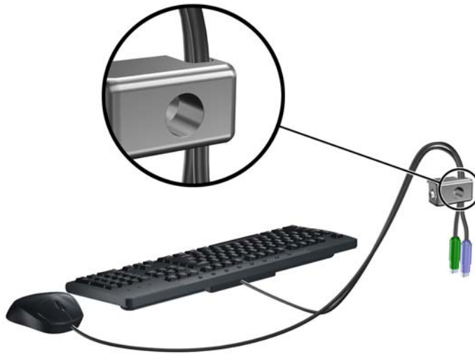
Gambar 3-38 Memasukkan Kabel Keyboard dan Kabel Mouse ke dalam lubang kunci.
