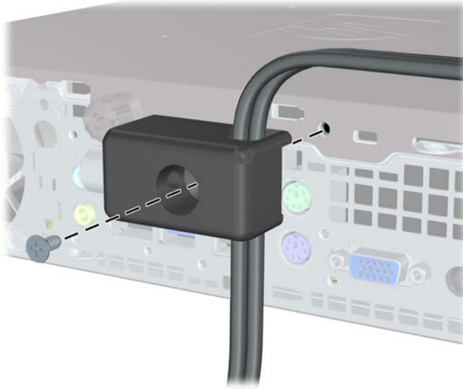
Gambar 5-32 Memasang Kunci pada Chassis
