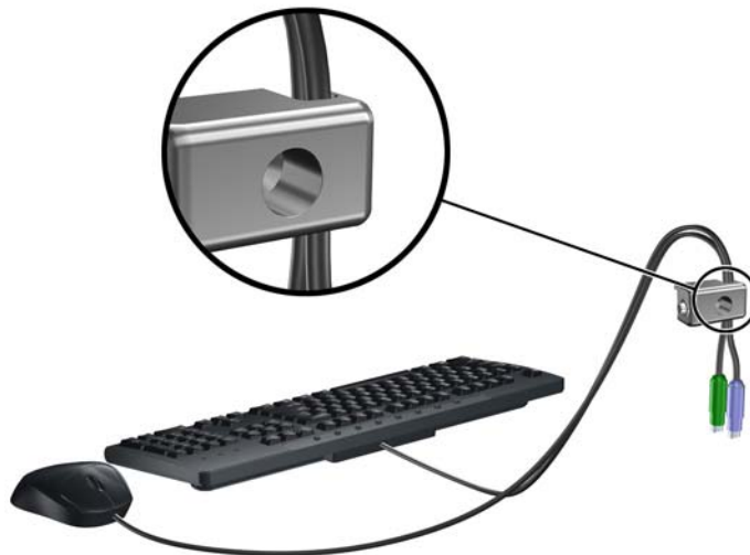
Gambar 4-46 Memasukkan Kabel Papan Ketik dan Kabel Tetikus
