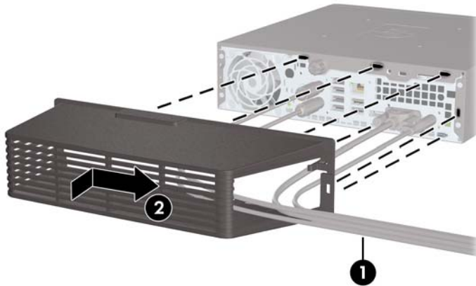
Gambar 5-22 Untuk Memasang Penutup Port
