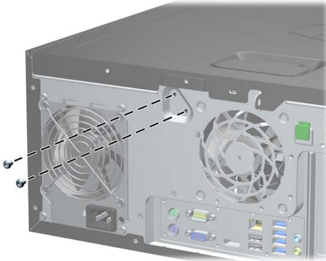
Gambar C-2 Membuka Sekrup Smart Cover Lock dari Microtower
