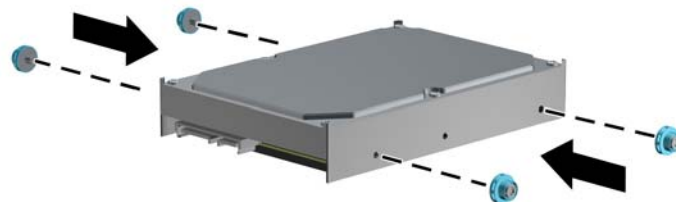
Gambar 2-25 Memasang Sekrup Pemandu Pemasangan Isolasi pada Hard Disk Berukuran 3,5 inci
