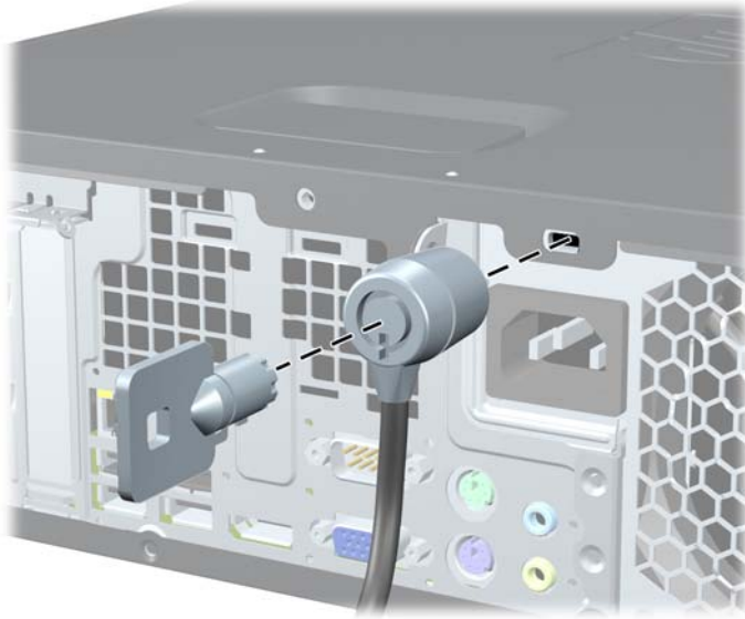
Gambar 4-40 Memasang Kunci Kabel
