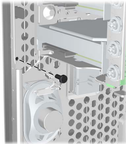
Gambar 3-43 Memasang Sekrup Pengaman Penutup Depan
