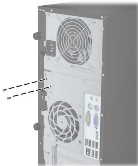
Gambar C-2 Membuka Sekrup Smart Cover Lock dari Microtower
