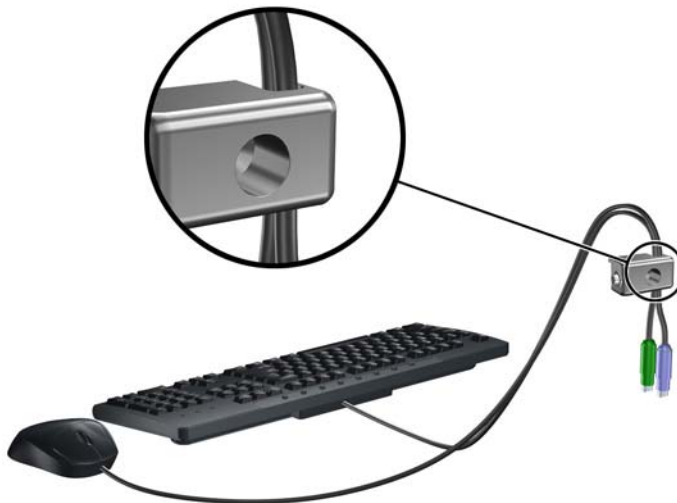
Gambar 2-45 Memasukkan Kabel Keyboard dan Kabel Mouse ke dalam lubang kunci.
