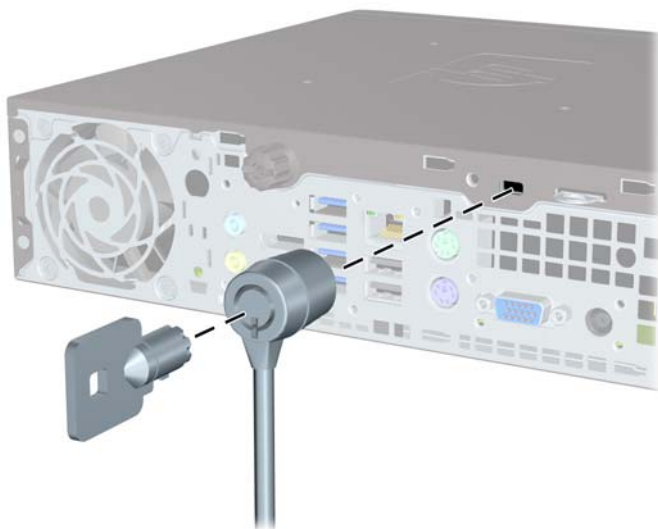
Gambar 5-25 Memasang Kunci Kabel dengan Penutup Port Terpasang
