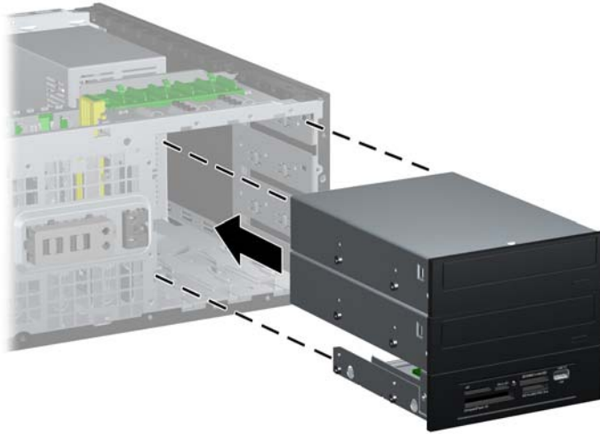
Attēls 2-34 Diskdziņa uzstādīšana galddatora konfigurācijā
