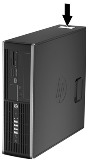
Attēls 1-16 Maza izmēra modeļa sērijas numura un produkta ID atrašanās vieta
