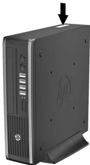
Attēls 1-17 Ultraplāna galdvirsmas datora (USDT) sērijas numura un produkta ID atrašanās vieta
