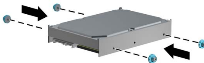
Joonis 4-37 Kõvaketta kinnituskruidide paigaldamine
