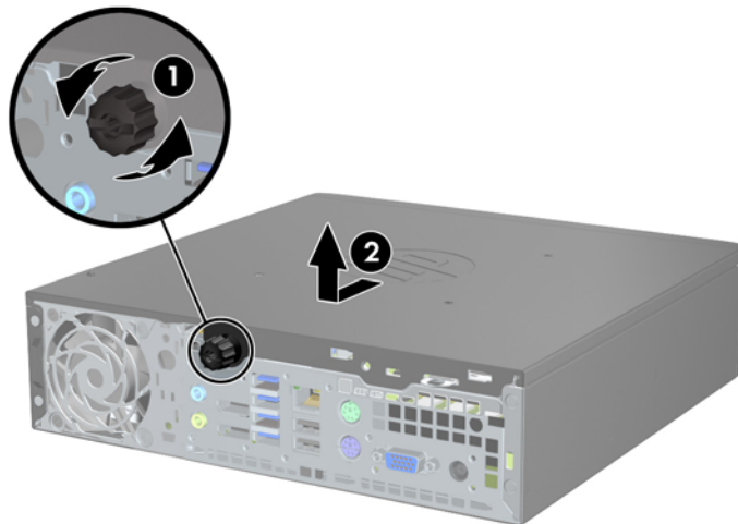
Joonis 5-2 Arvuti külgpaneeli eemaldamine
