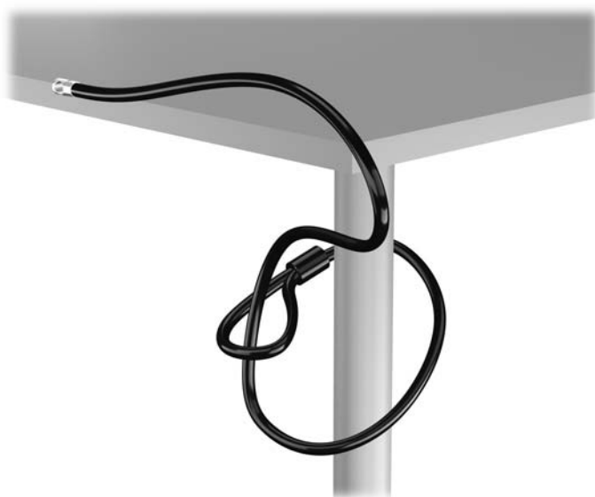
Joonis 3-34 Kaabli kinnitamine kindlalt püsiva objekti külge
