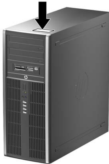
Joonis 1-14 Convertible Minitower – seerianumbri ja toote ID-numbri asukoht
