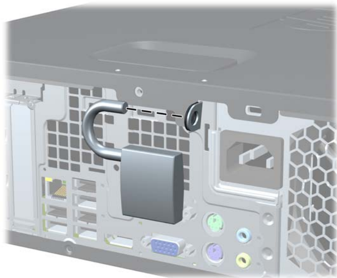
Joonis 4-41 Tabaluku paigaldamine
