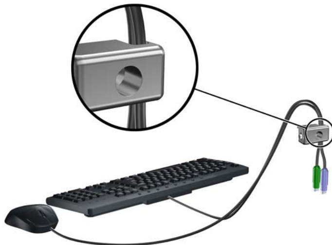
Joonis 3-38 Klaviatuuri ja hiire ühenduskaablite kinnitamine
