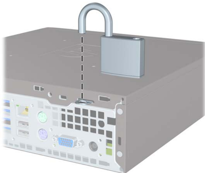
Joonis 5-26 Tabaluku paigaldamine
