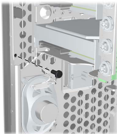
Joonis 3-43 Esipaneeli turvakruvi paigaldamine
