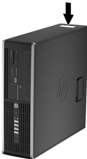
Joonis 1-16 Small Form Factor – seerianumbri ja toote ID-numbri asukoht
