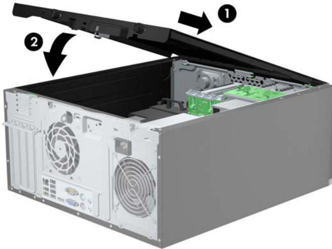
Joonis 3-2 Arvuti külgpaneeli tagasipanek
