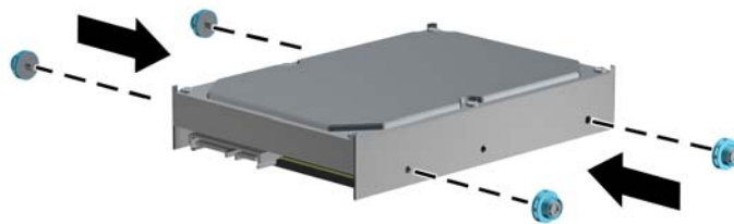
Figura 3-26 Instalación de los tornillos guía de montaje en una unidad de 3,5 pulgadas
