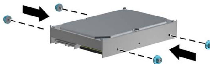
Figura 4-37 Instalación de los tornillos guía en la unidad de disco duro
