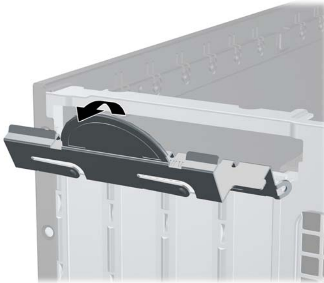
Figura 4-10 Apertura del pestillo de la ranura de expansión
