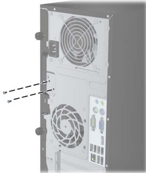
Figura C-2 Extracción de los tornillos del bloqueo inteligente de cubierta de la Microtorre
