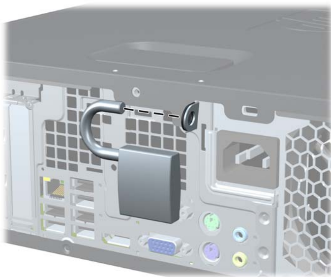
Figura 4-41 Instalación de un candado
