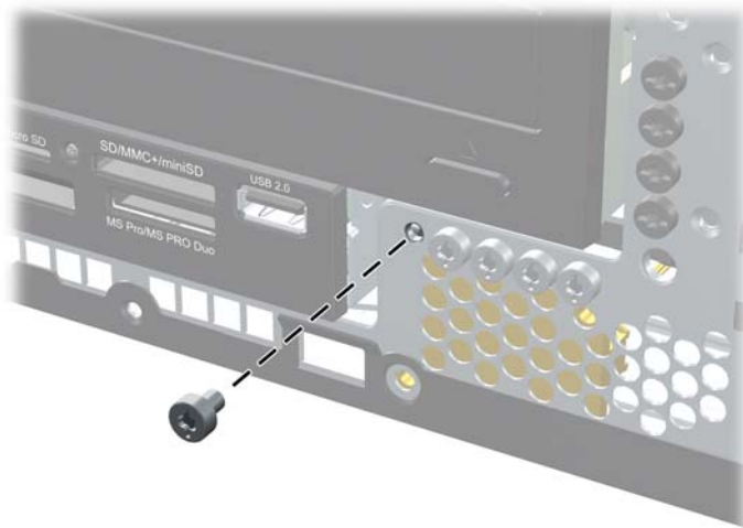
Figura 4-50 Extracción del tornillo de seguridad del panel frontal
