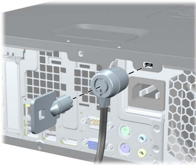
Figura 4-40 Instalación de un bloqueo de cable
