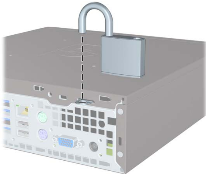
Figura 5-26 Instalación de un candado
