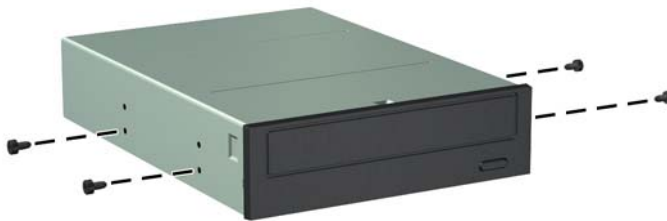
Figura 4-22 Instalación de tornillos guía en la unidad óptica
