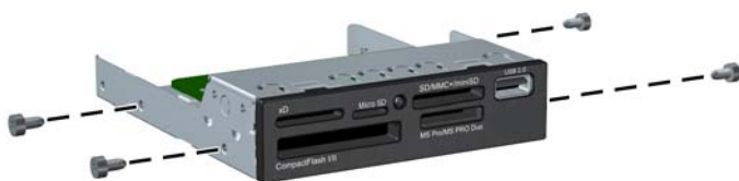
Figura 4-29 Instalación de tornillos guía (se muestra un lector de tarjetas multimedia)
