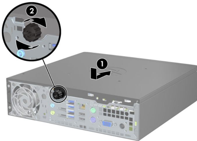
Figura 5-3 Reinstalación del panel de acceso del equipo
