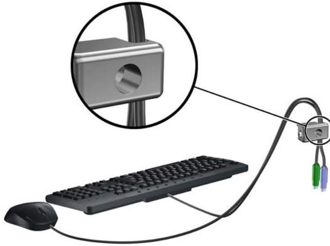
Figura 2-45 Enroscado de los cables del teclado y del mouse
