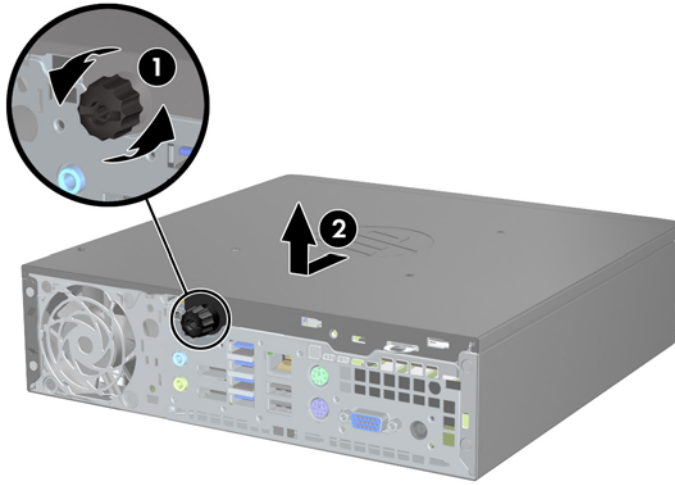
Figura 5-2 Extracción del panel de acceso del equipo
