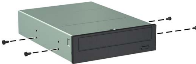
Abbildung 3-22 Installieren von Führungsschrauben am optischen Laufwerk
