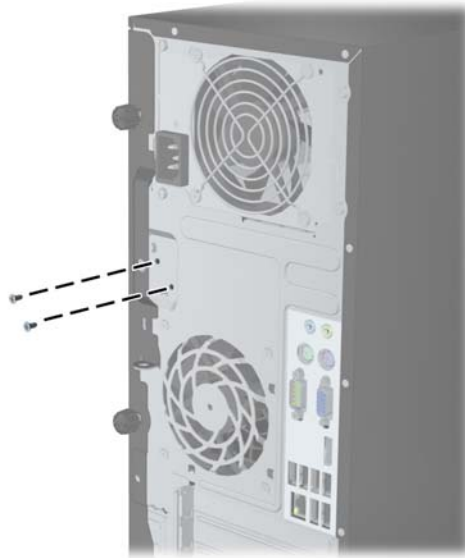
Abbildung C-2 Entfernen der Schrauben der Smart Cover-Sperre des Small Form Factor
