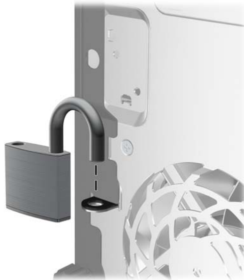
Abbildung 2-33 Anbringen eines Vorhängeschlosses
