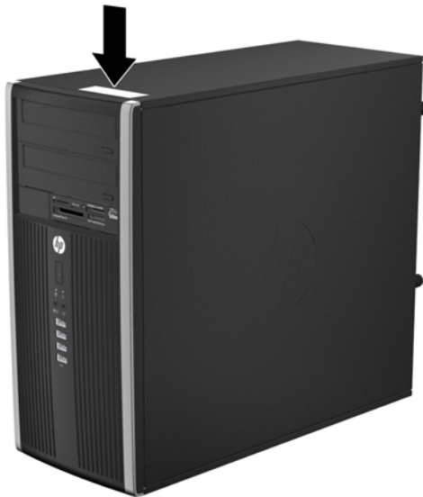
Abbildung 1-8 Position von Seriennummer und Produkt-ID des Microtower
