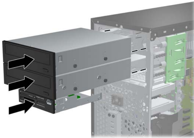
Abbildung 2-21 Hineinschieben des Laufwerks in den Laufwerkrahmen
