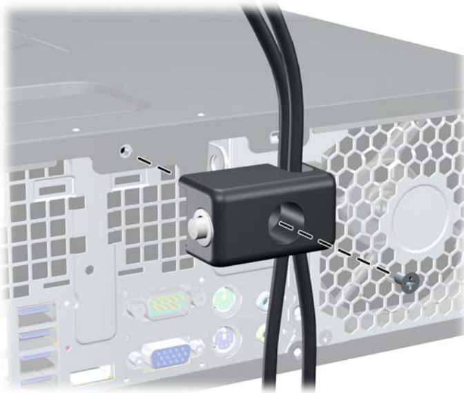
Abbildung 3-47 Befestigen der Sperre am Gehäuse
