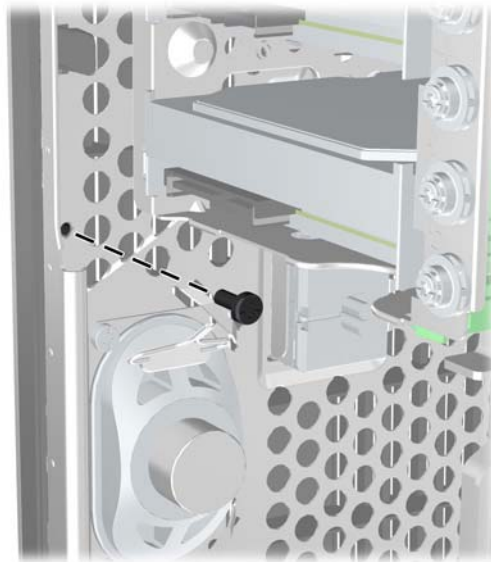
Abbildung 2-43 Installieren der Sicherheitsschraube für die Frontblende
