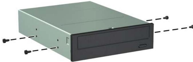
9. Posicione os parafusos-guia na unidade nos slots J do compartimento. Em seguida, deslize a unidade na direção frontal do computador até que ela trave no local.
