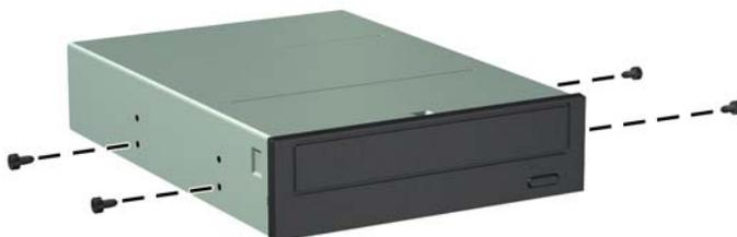
8. Deslize a unidade para dentro do compartimento, assegurando-se de alinhar os parafusos-guia com os slots, até a unidade encaixar-se em seu lugar.
