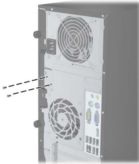
**Figura C-2** Remoção dos parafusos de trava da Smart Cover no Formato Compacto
