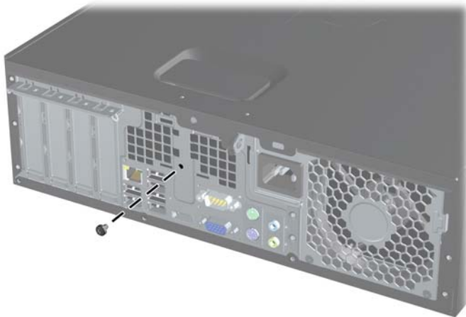
ภาพ C-2 การถอดสกรูล็อก Smart Cover Lock ออกจาก Small Form Factor
