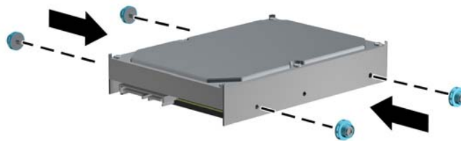
ภาพ 3-37 การติดตั้งสกรูตัวนำของฮาร์ดไดรฟ์
