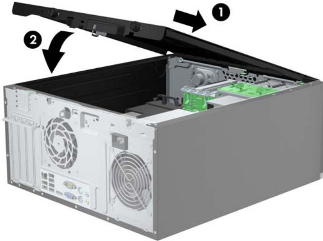
ภาพ 2-2 การใส่แผงปิดเครื่องคอมพิวเตอร์กลับเข้าที่
