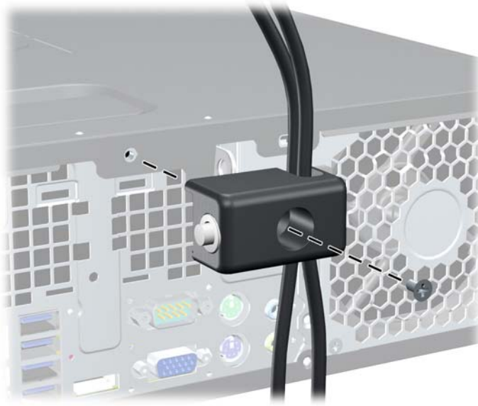
ภาพ 3-47 การใส่ล็อกกับเครื่องโครงเครื่อง
