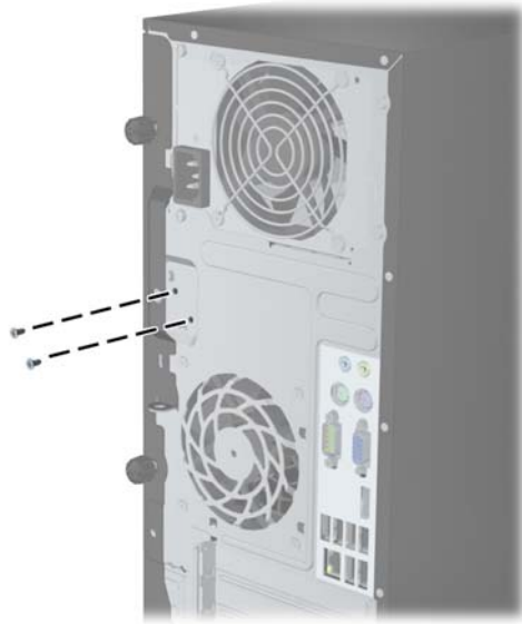
ภาพ C-2 การถอดสกรูล็อก Smart Cover Lock ออกจาก Small Form Factor
