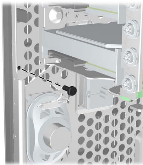
ภาพ 2-43 การติดตั้งสกรูรักษาความปลอดภัยสำหรับแผงด้านหน้า
