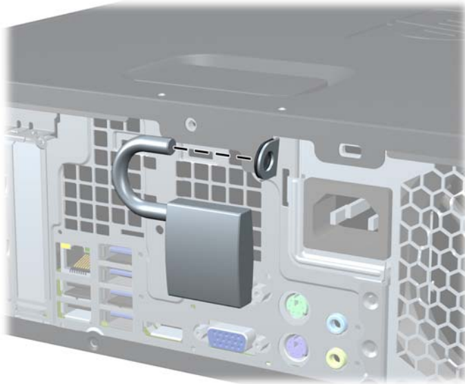
ภาพ 3-41 การติดตั้งกุญแจล็อค
