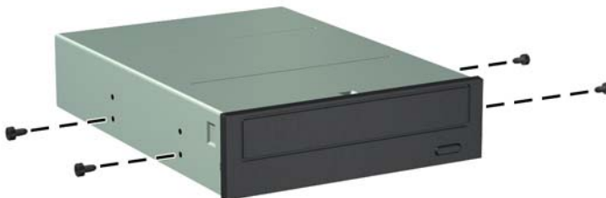
ภาพ 3-22 การติดตั้งสกรูตัวนำในไดรฟ์ออปติคัล
