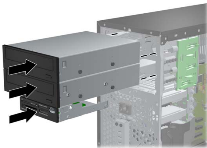
図 2-21 ドライブ ケージへのドライブの取り付け
