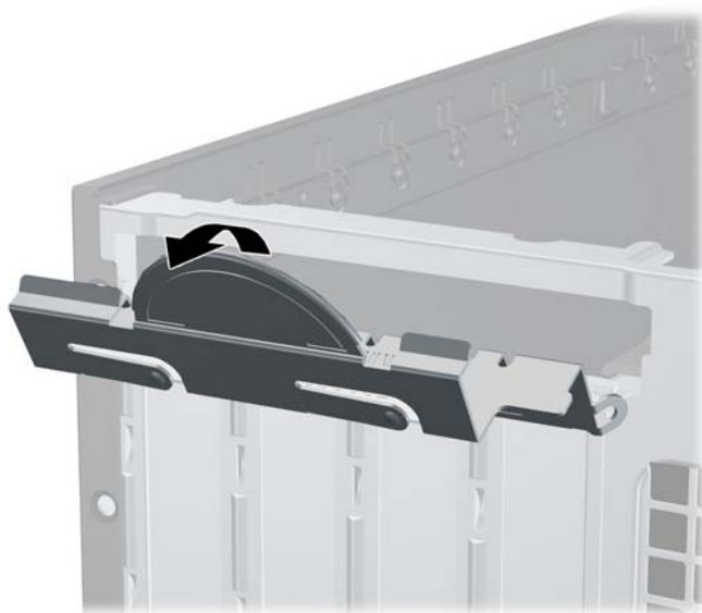
図 3-10 拡張スロットの固定ラッチを開く
