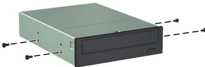
図 2-20 ガイド用ネジの取り付け（図はオプティカル ドライブ）
