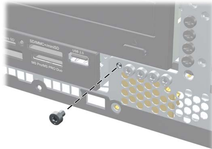
図 3-50 フロント パネルのセキュリティ ネジの取り外し
