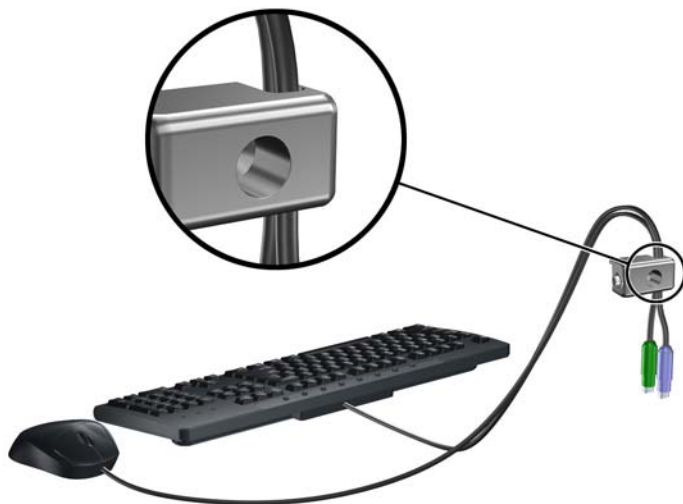
図 2-38 キーボードとマウスのケーブルによる固定
