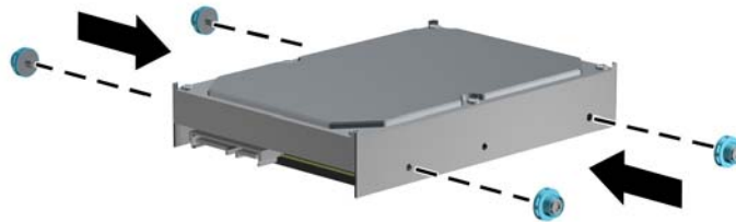
図 3-37 ハードディスク ドライブのガイド用ネジの取り付け
