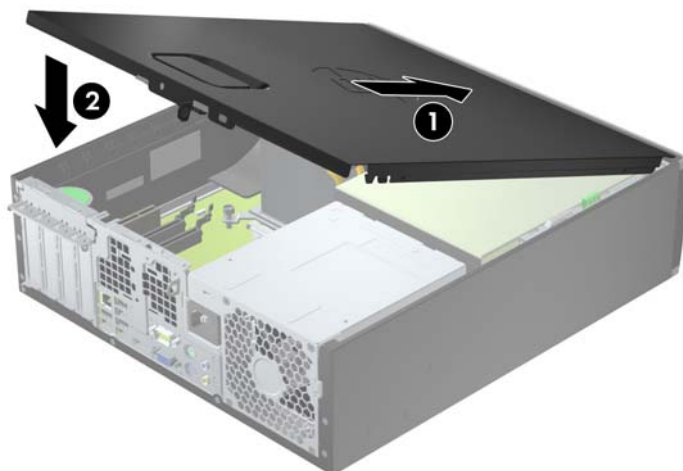
図 3-2 コンピューターのアクセス パネルの取り付け
