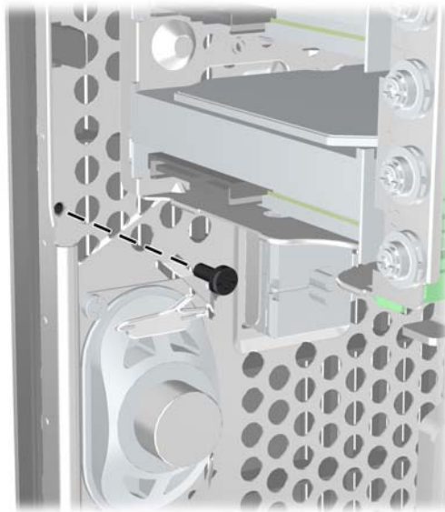
図 2-43 フロント パネルのセキュリティ ネジの取り付け
