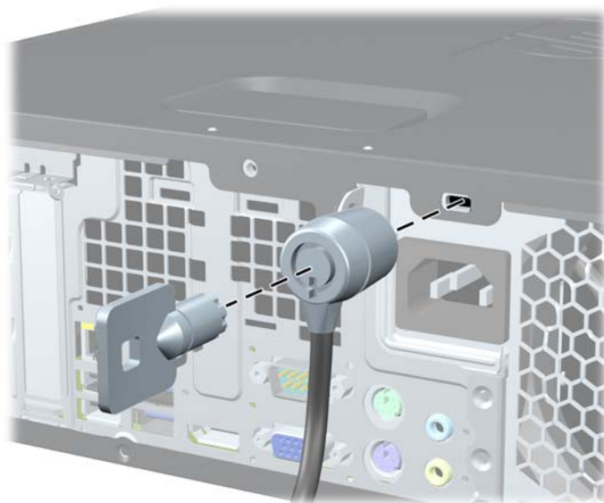
図 3-40 ロック ケーブルの取り付け
