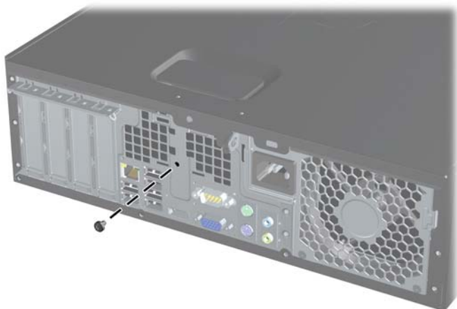
図 C-2 省スペース型からのスマート カバー ロックの不正防止ネジの取り外し
