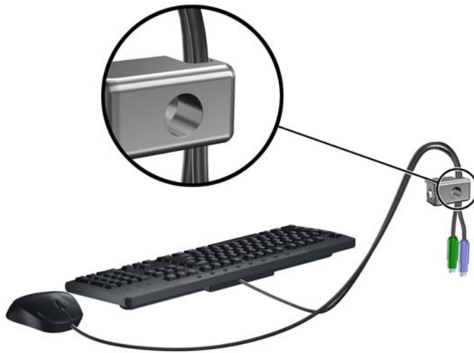
図 3-46 キーボードとマウスのケーブルによる固定
