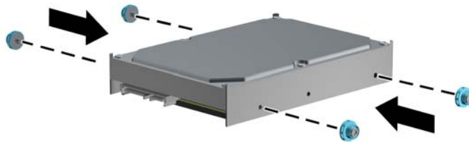
図 2-26 3.5 インチ ドライブへのガイド用分離取り付けネジの取り付け
